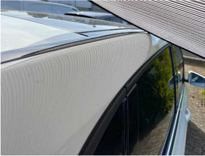
Dach (Lackschaden, Unsachgemäß instand gesetzt)
