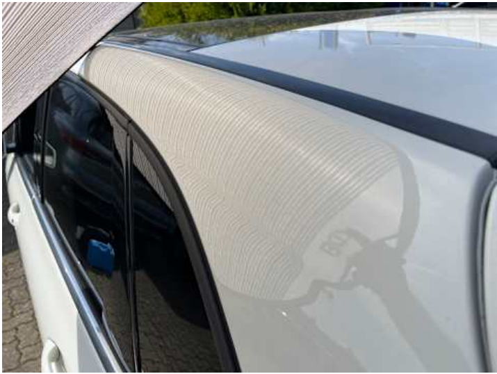
Dach (Lackschaden, Unsachgemäß instand gesetzt)
