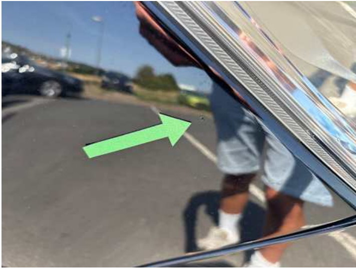
Kotflügel vorne rechts (Delle, Rost)
