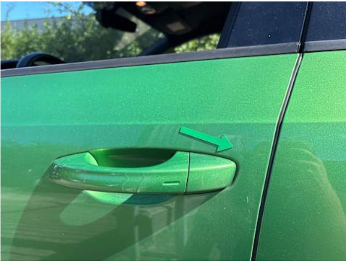
Fahrertür (Lackschaden, Unsachgemäß instand gesetzt)
