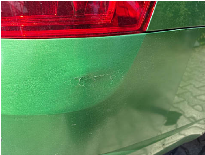
Stoßstange hinten (Lackschaden, Unsachgemäß instand gesetzt, Verformung)
