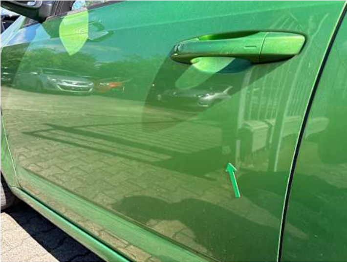
Fahrertür (Lackschaden, Unsachgemäß instand gesetzt)
