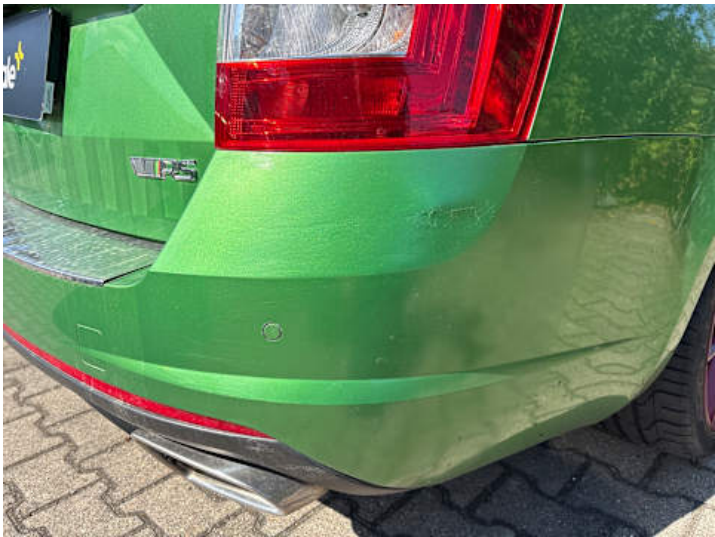
Stoßstange hinten (Lackschaden, Unsachgemäß instand gesetzt, Verformung)
