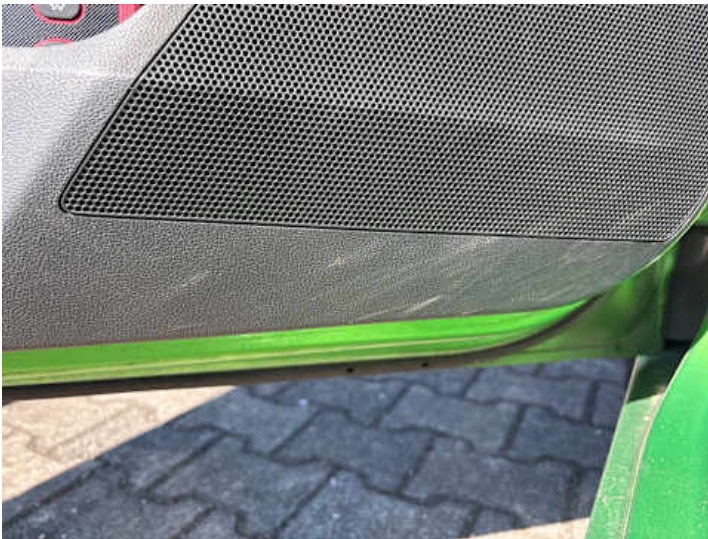
Innenraum (Verschleiß, Kratzer)
