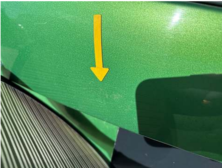
Heckklappe (Delle, Verformung, Lackschaden)
