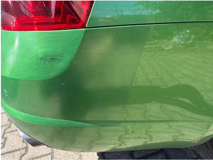
Stoßstange hinten (Lackschaden, Unsachgemäß instand gesetzt, Verformung)
