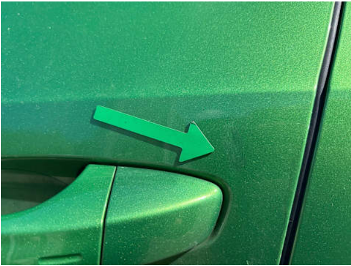
Fahrertür (Lackschaden, Unsachgemäß instand gesetzt)
