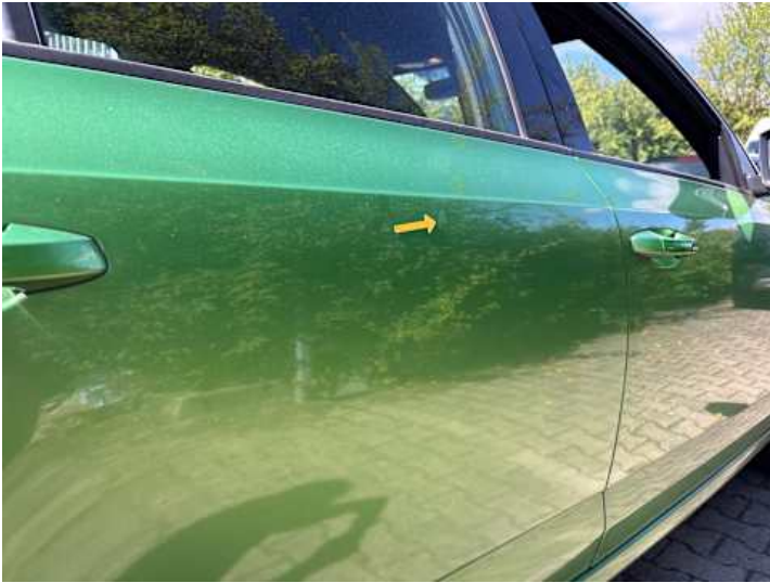
Türe hinten rechts (Kratzer, Lackschaden, Unsachgemäß instand gesetzt)
