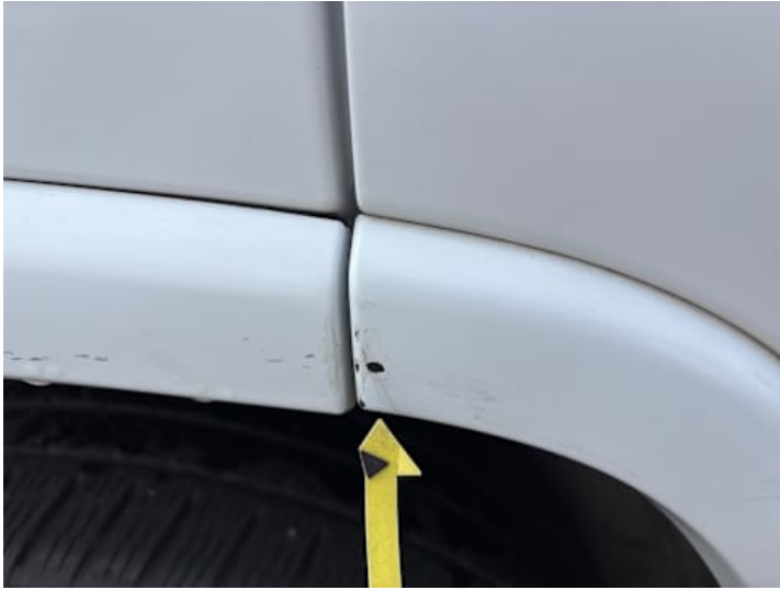
Türe hinten rechts (Delle, Kratzer)
