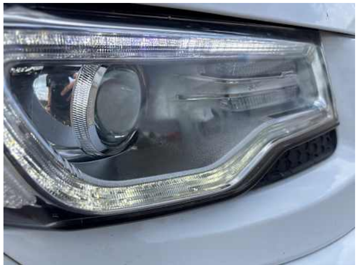
Scheinwerfer (rechts) (Blind, Undicht)
