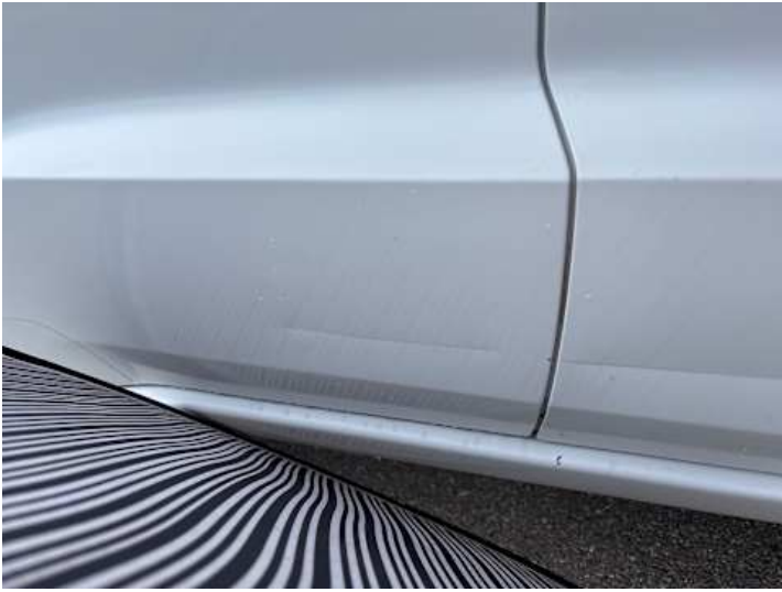
Türe hinten rechts (Delle, Kratzer)
