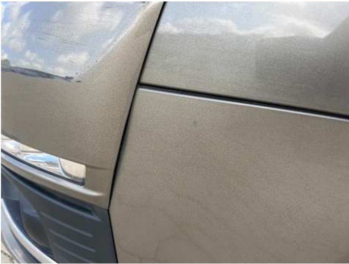
Stoßstange vorne (Spaltmaße ungenau)
