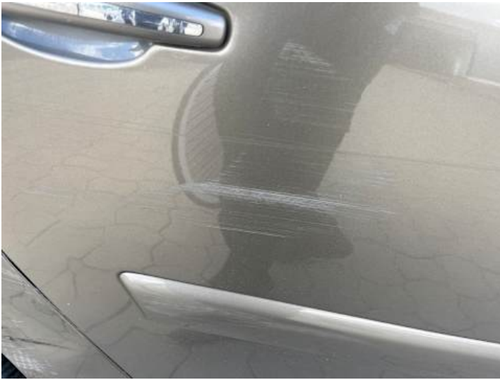
Türe hinten rechts (Kratzer, Lackschaden)
