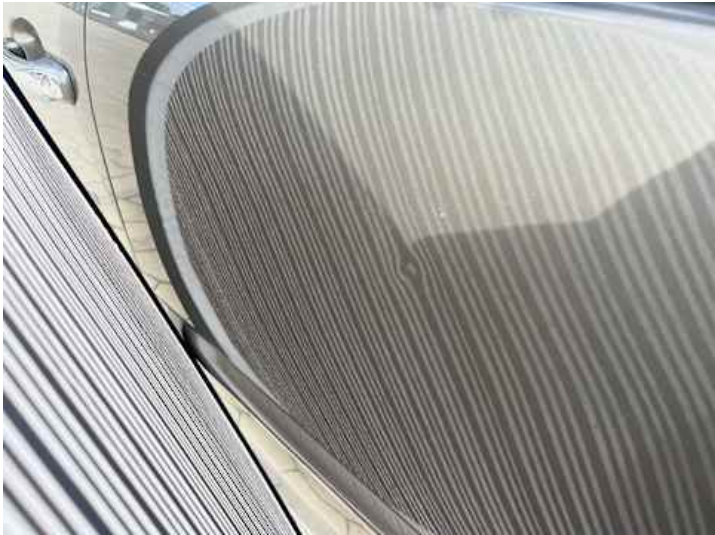
Türe hinten links (Delle)
