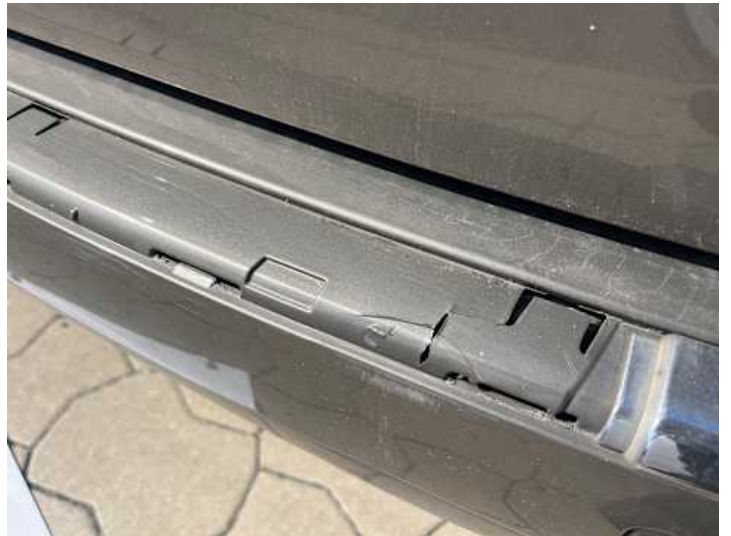
Stoßstange hinten (Riss/Bruch)
