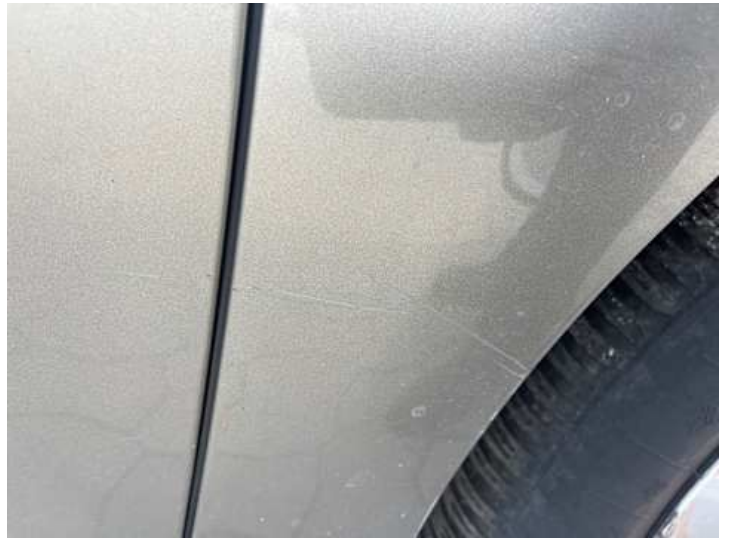
Kotflügel vorne rechts (Kratzer, Lackschaden)
