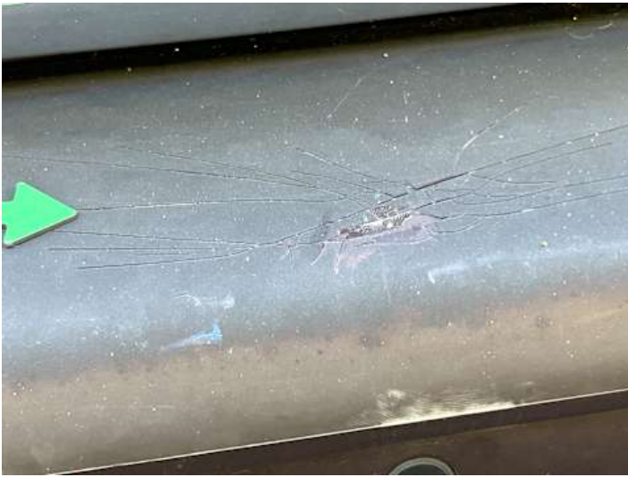
Stoßstange hinten (Kratzer, Verformung)
