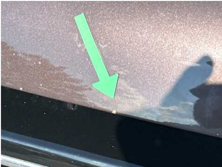
Motorhaube (Steinschlag, Rost)
