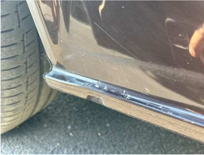
Schweller links (Kratzer, Rost, Lackschaden)
