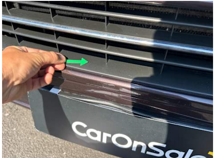
Stoßstange vorne (Riss/Bruch)
