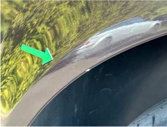
Seitenteil hinten rechts (Kratzer)
