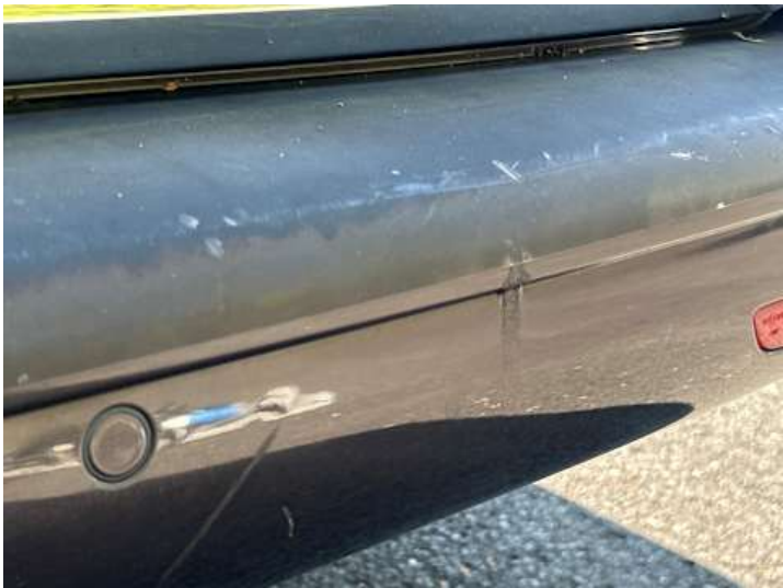
Stoßstange hinten (Kratzer, Verformung)
