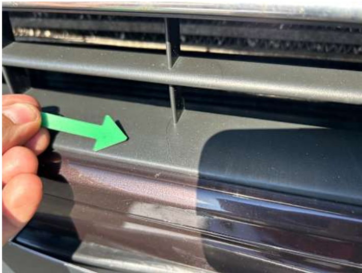
Stoßstange vorne (Riss/Bruch)
