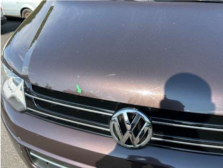
Motorhaube (Steinschlag, Rost)
