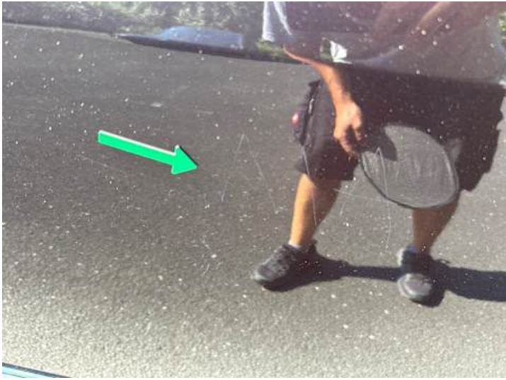
Seitenteil hinten links (Kratzer, Rost)
