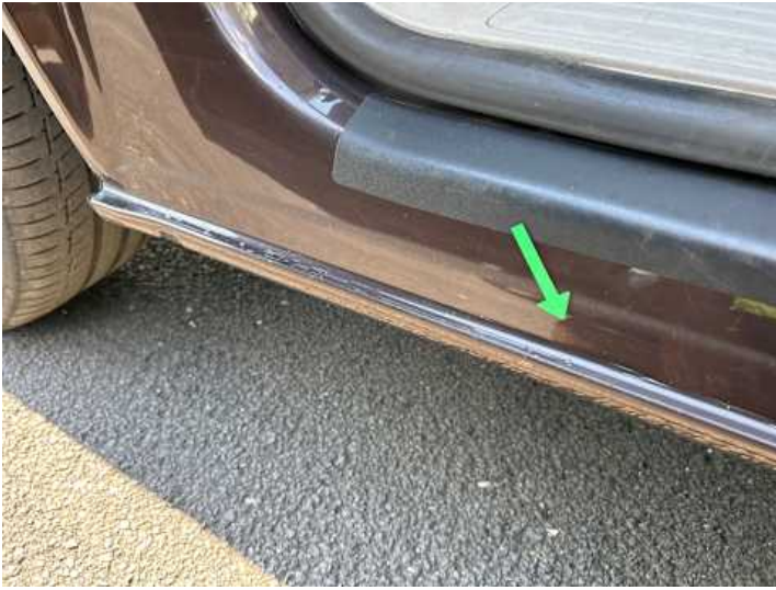
Schweller links (Kratzer, Rost, Lackschaden)
