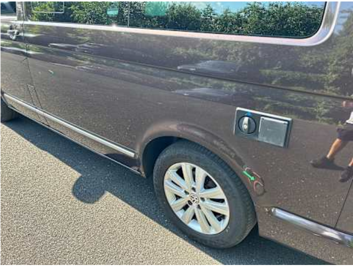
Seitenteil hinten links (Kratzer, Rost)
