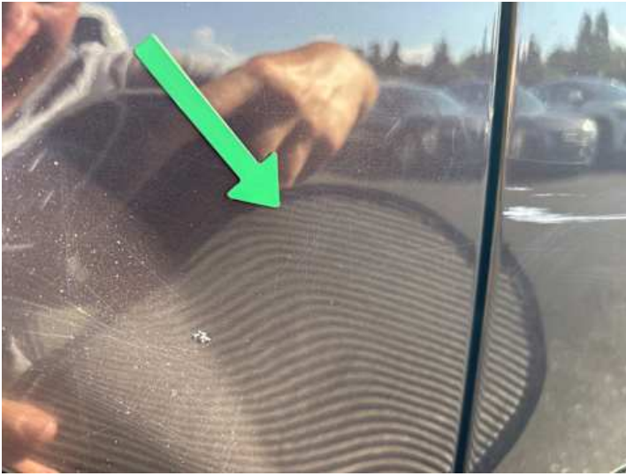
Seitenteil hinten rechts (Rost, Unsachgemäß instand gesetzt)
