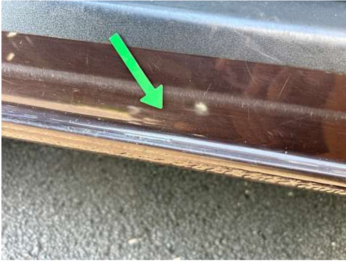
Schweller links (Kratzer, Rost, Lackschaden)
