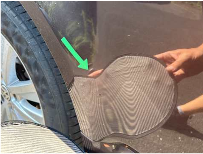
Seitenteil hinten links (Kratzer, Rost)
