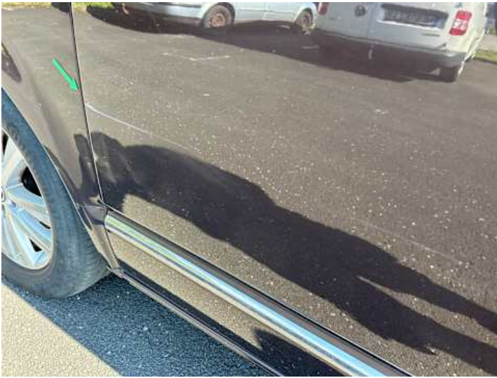
Türe hinten rechts (Verformung, Kratzer, Unsachgemäß instand gesetzt)
