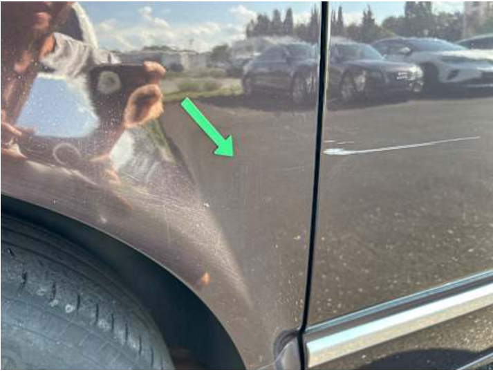
Seitenteil hinten rechts (Rost, Unsachgemäß instand gesetzt)
