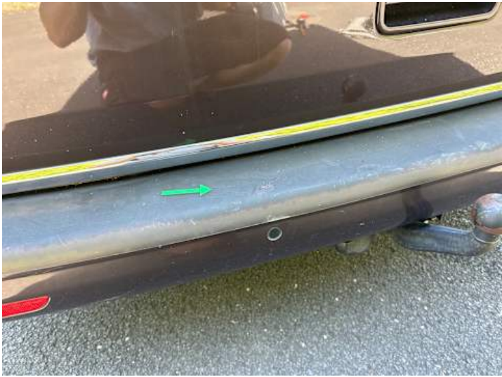
Stoßstange hinten (Kratzer, Verformung)
