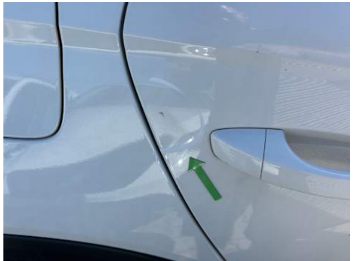
Türe hinten rechts (Lackschaden)
