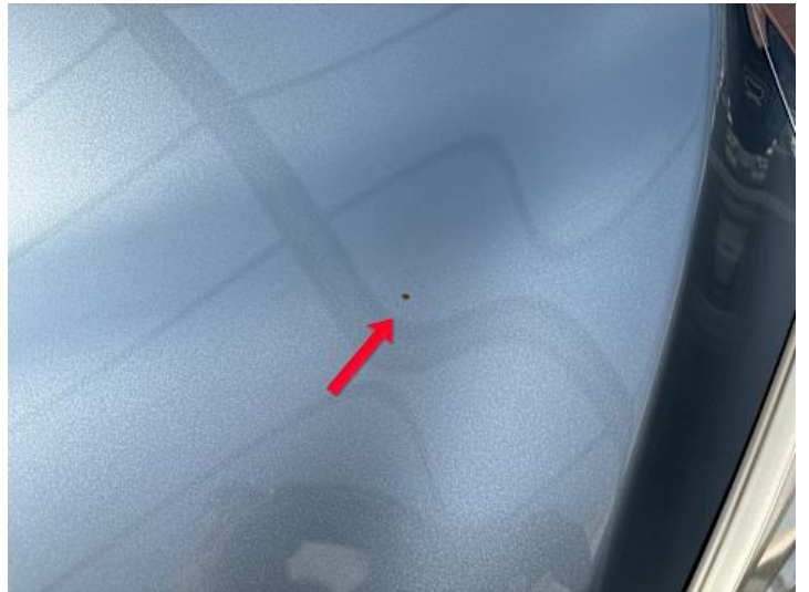
Motorhaube (Steinschlag, Rost)
