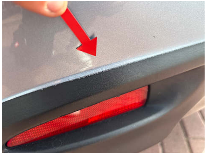
Stoßstange hinten (Unsachgemäß instand gesetzt)
