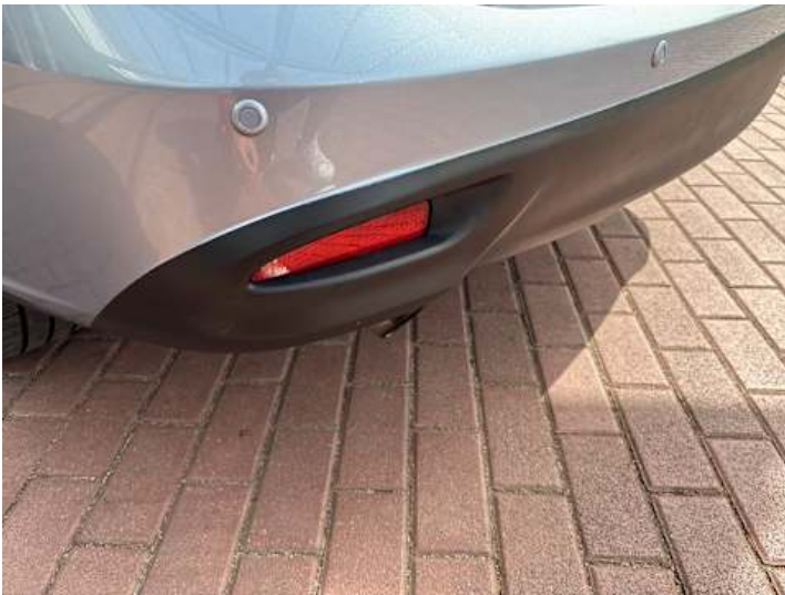
Stoßstange hinten (Unsachgemäß instand gesetzt)
