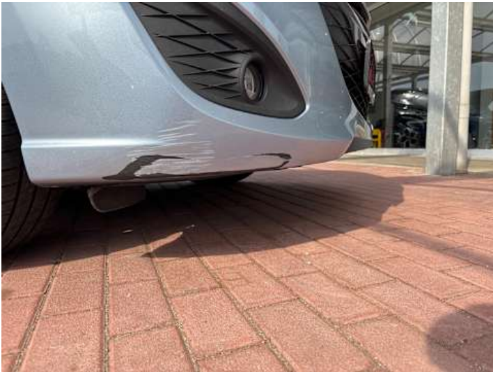
Stoßstange vorne (Lackschaden, Verformung)
