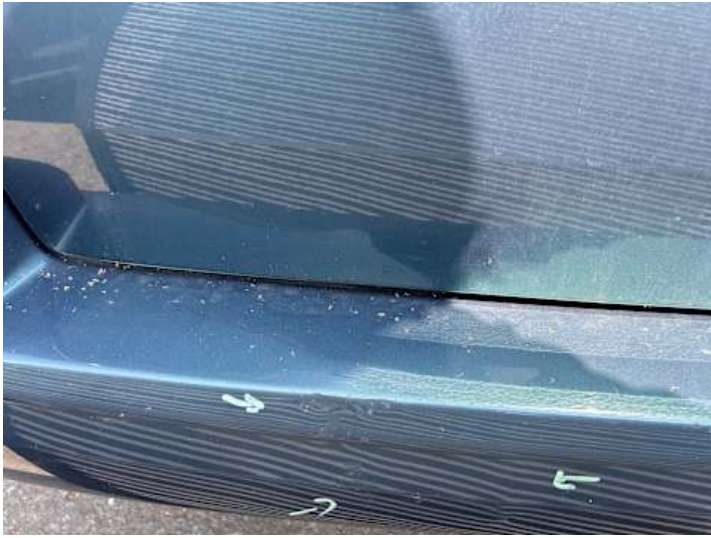
Stoßstange hinten (Delle, Kratzer)
