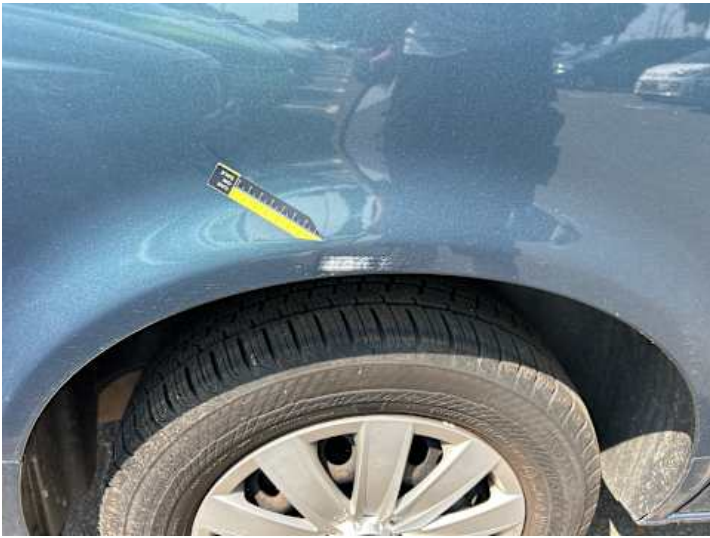
Seitenteil hinten rechts (Lackschaden, Delle)
