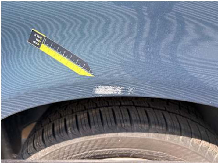
Seitenteil hinten rechts (Lackschaden, Delle)
