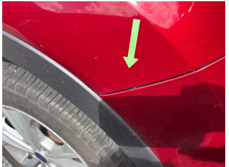
Seitenteil hinten links (Spaltmaße ungenau)
