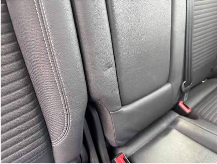
Innenraum (Anderer Schaden): Druckstellen
