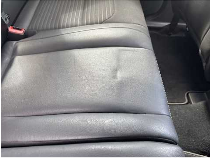
Innenraum (Anderer Schaden): Druckstellen
