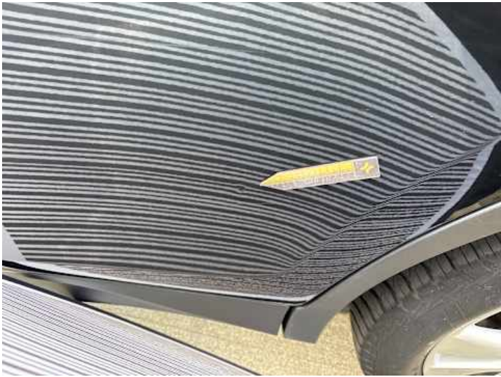
Türe hinten links (Delle)
