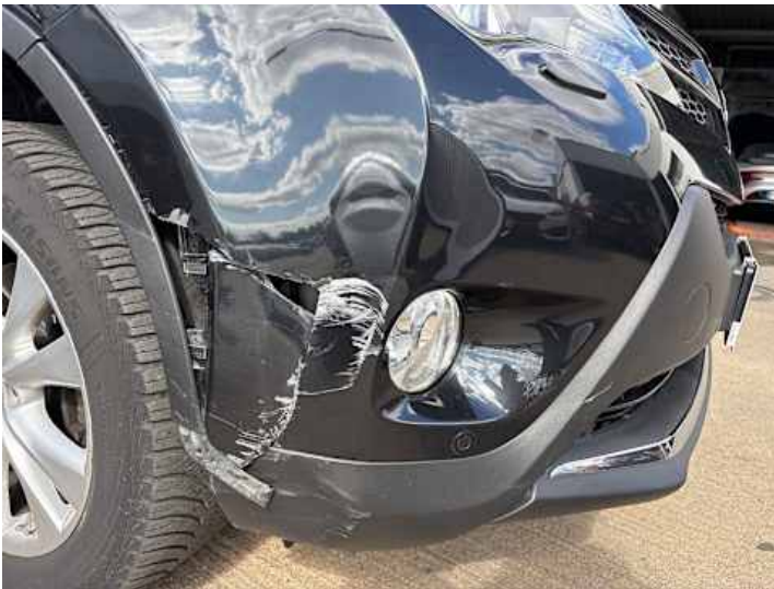
Stoßstange vorne (Kratzer, Riss/Bruch, Spaltmaße ungenau)
