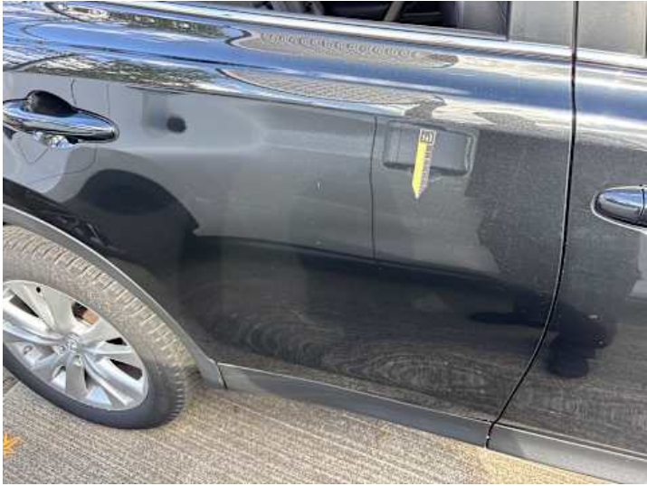
Türe hinten rechts (Delle)
