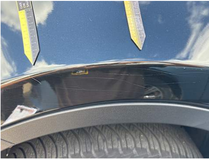
Kotflügel vorne links (Kratzer)
