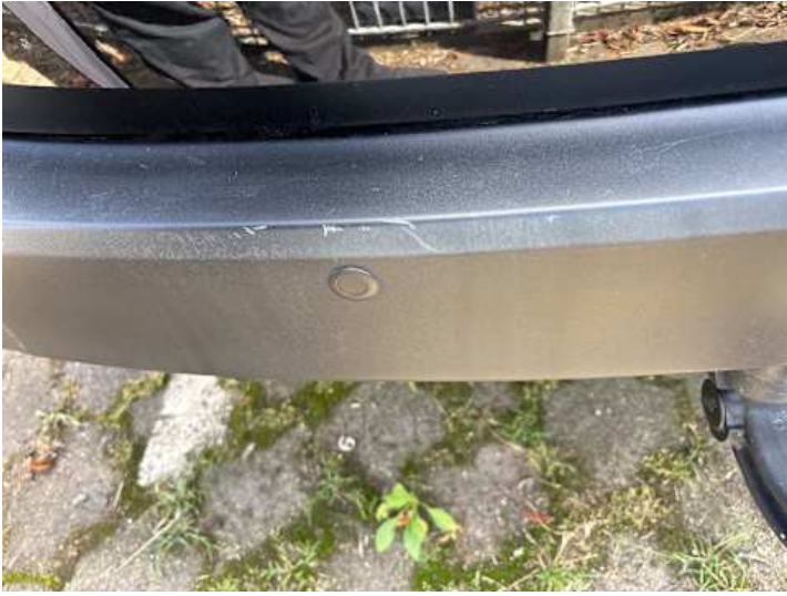
Stoßstange hinten (Kratzer)
