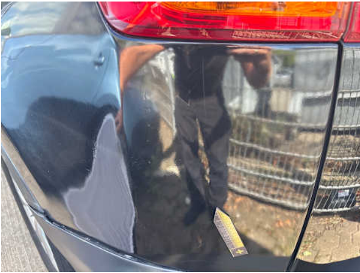
Seitenteil hinten links (Lackschaden, Unsachgemäß instand gesetzt)
