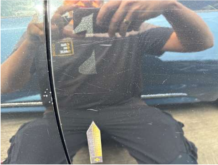
Türe hinten links (Kratzer)
