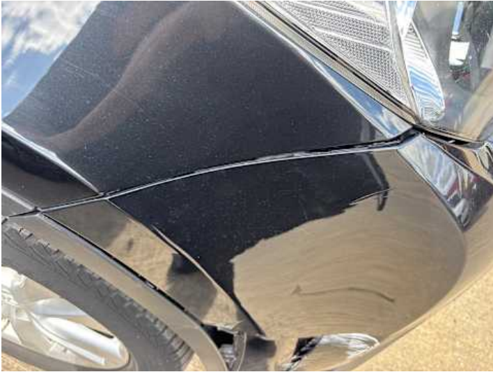
Stoßstange vorne (Kratzer, Riss/Bruch, Spaltmaße ungenau)
