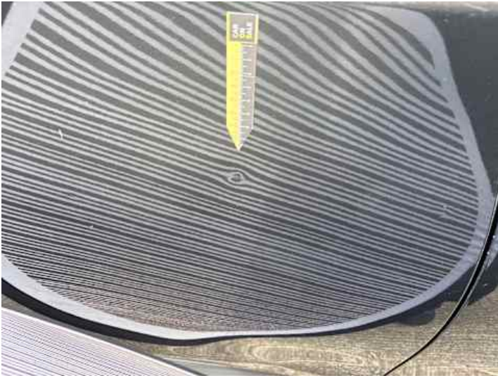
Türe hinten rechts (Delle)
