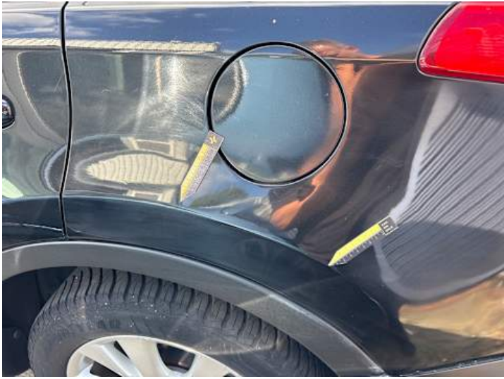
Seitenteil hinten links (Ausgeblinden/Matt)
