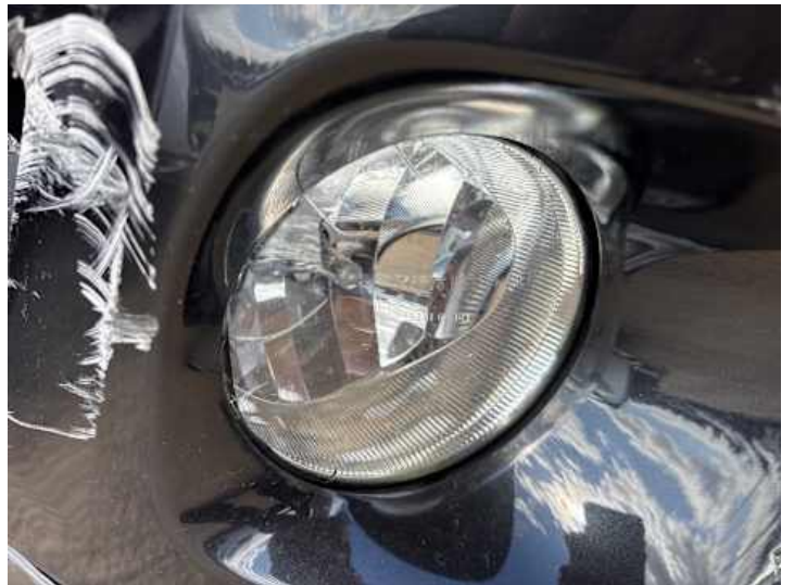
Scheinwerfer (rechts) (Riss/Bruch)
