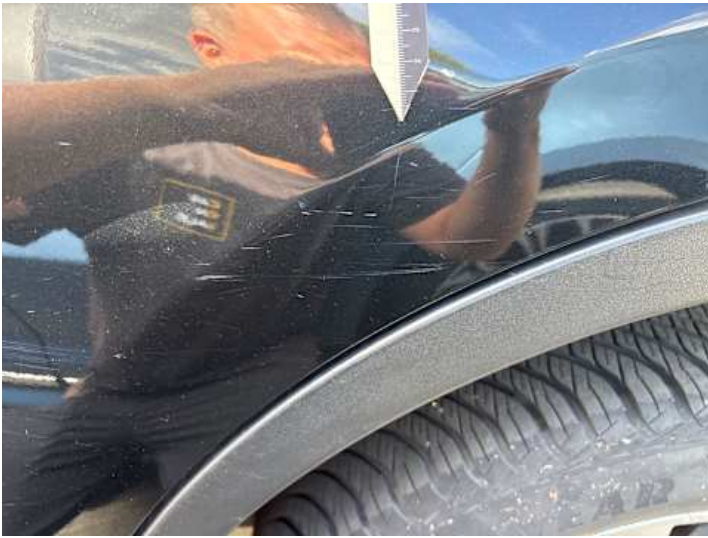
Türe hinten links (Kratzer)
