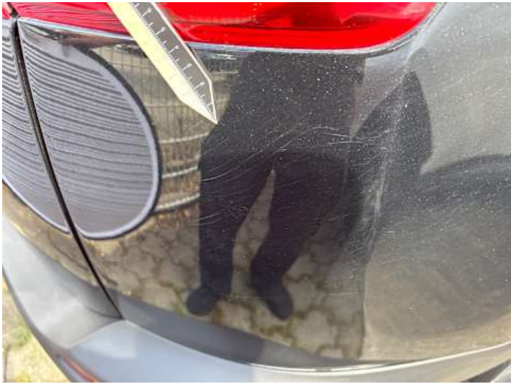
Seitenteil hinten rechts (Kratzer)
