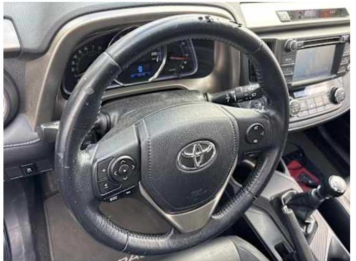
Innenraum (Riss/Bruch, Verschleiß)
