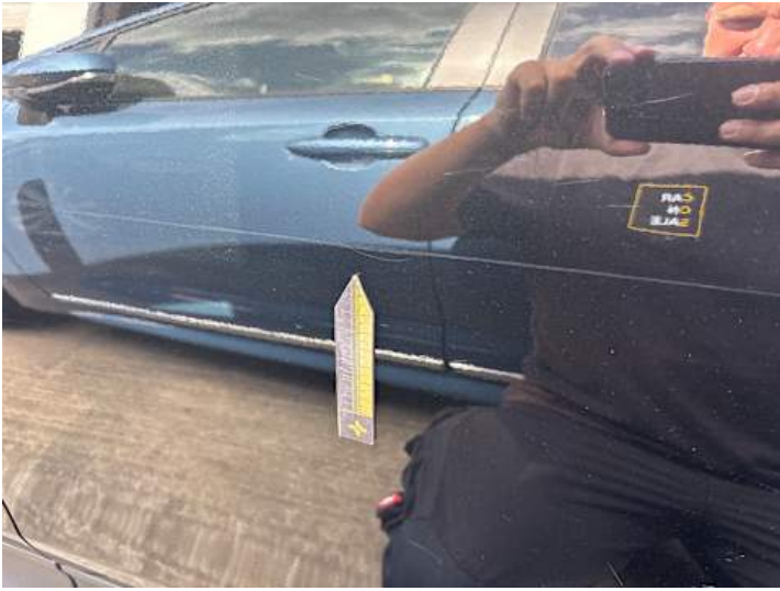
Türe hinten links (Kratzer)
