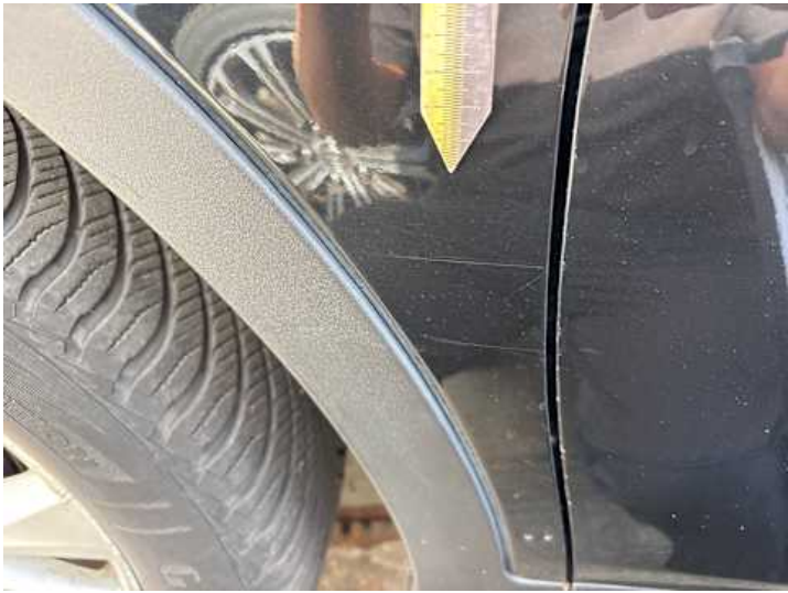
Kotflügel vorne links (Kratzer)
