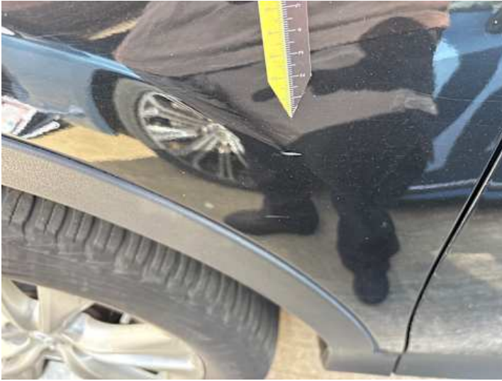
Kotflügel vorne links (Kratzer)
