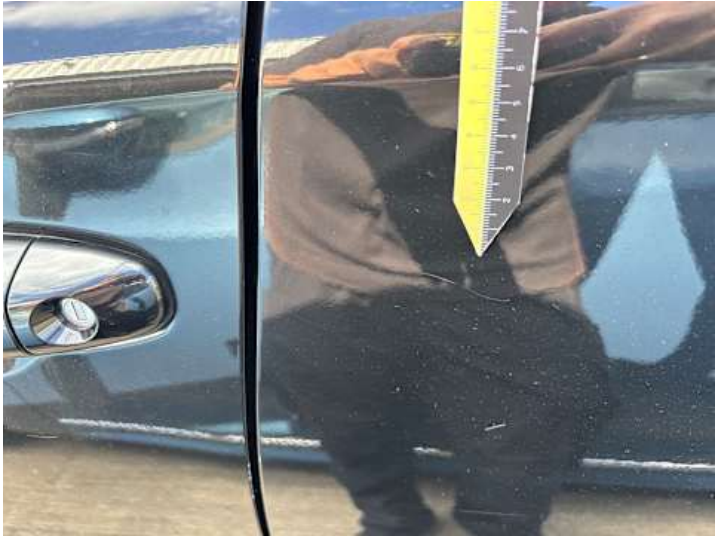
Türe hinten links (Kratzer)
