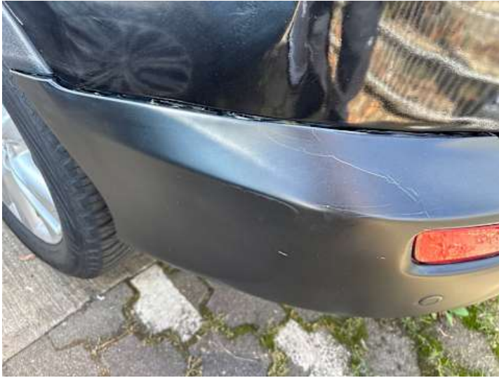
Stoßstange hinten (Lackschaden, Unsachgemäß instand gesetzt, Spaltmaße ungenau)
