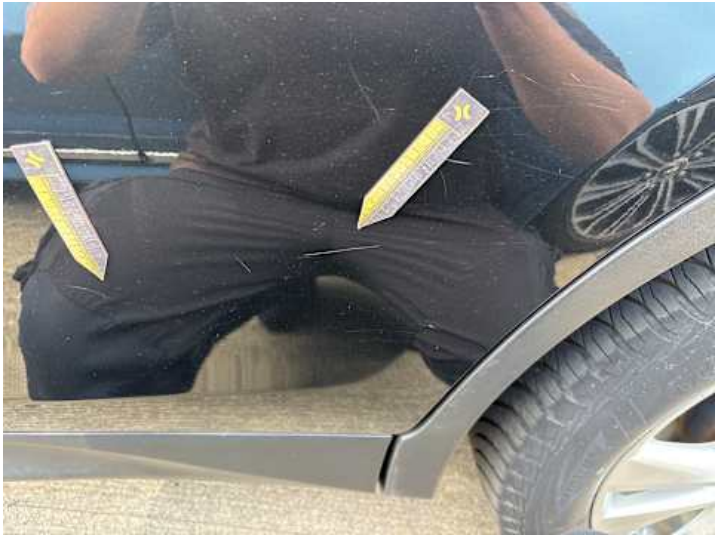
Türe hinten links (Kratzer)
