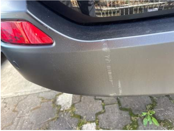
Stoßstange hinten (Kratzer)
