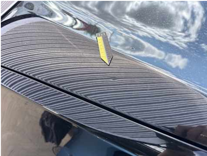
Motorhaube (Delle, Kratzer)
