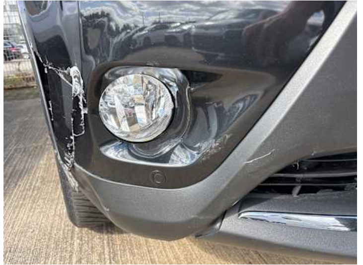
Stoßstange vorne (Kratzer, Riss/Bruch, Spaltmaße ungenau)
