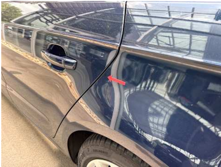
Seitenteil hinten links (Delle)
