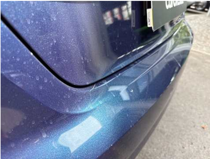
Stoßstange hinten (Kratzer, Lackschaden)
