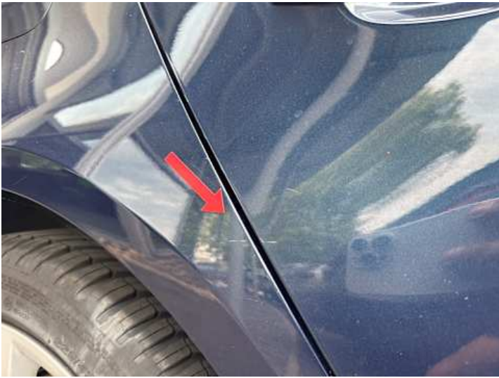
Türe hinten rechts (Kratzer, Lackschaden)
