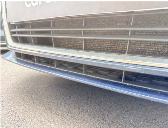
Stoßstange vorne (Lackschaden, Steinschlag)
