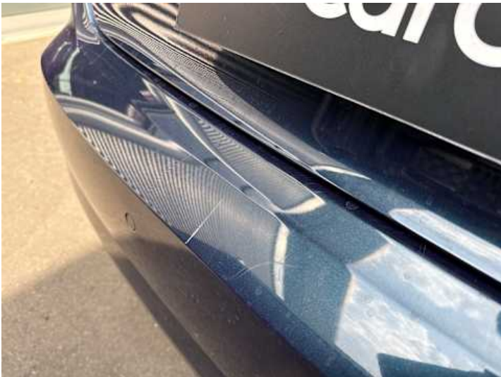
Stoßstange hinten (Kratzer, Lackschaden)
