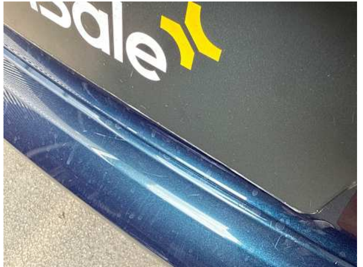
Stoßstange hinten (Kratzer, Lackschaden)
