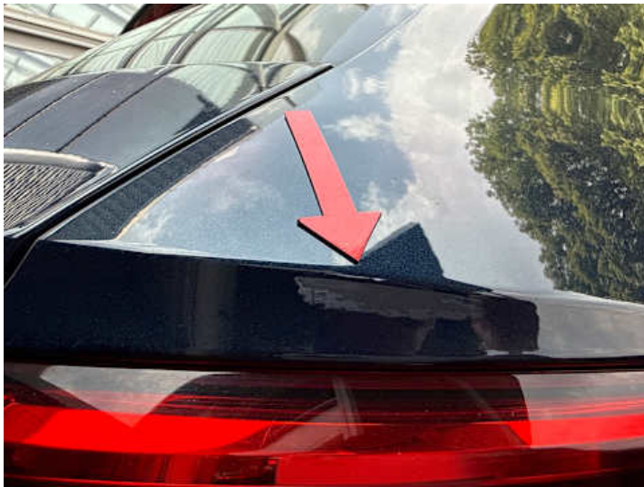
Seitenteil hinten rechts (Lackschaden)
