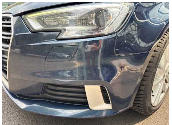
Stoßstange vorne (Lackschaden, Steinschlag)
