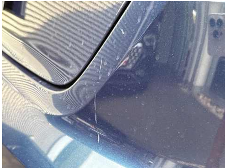
Stoßstange hinten (Kratzer, Lackschaden)
