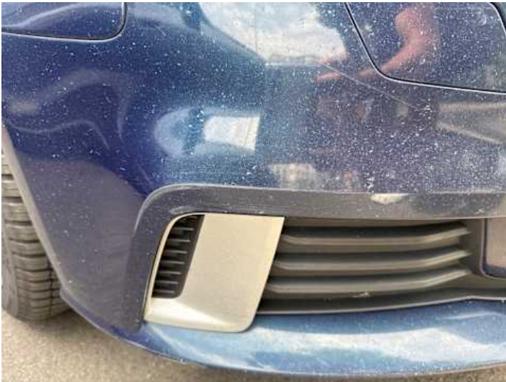
Stoßstange vorne (Lackschaden, Steinschlag)
