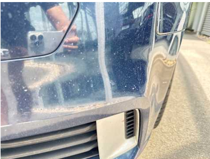
Stoßstange vorne (Lackschaden, Steinschlag)
