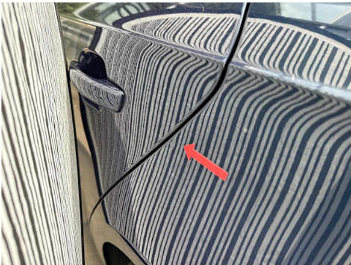
Seitenteil hinten links (Delle)
