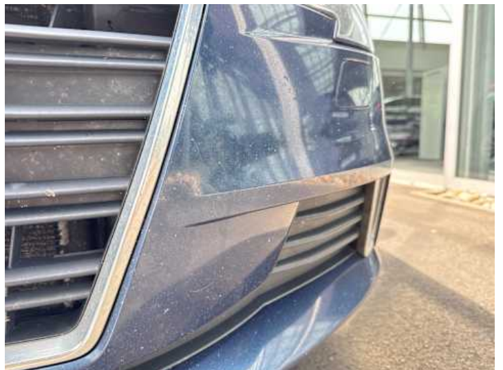
Stoßstange vorne (Lackschaden, Steinschlag)
