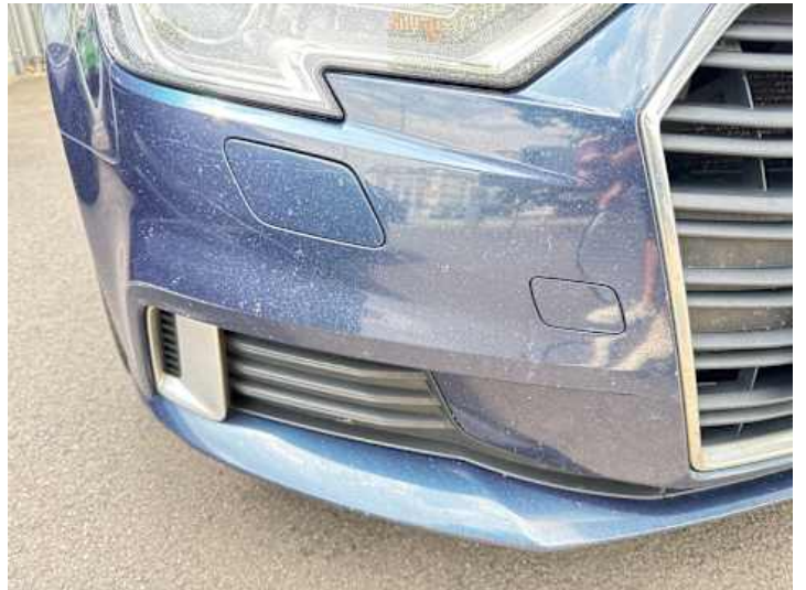
Stoßstange vorne (Lackschaden, Steinschlag)
