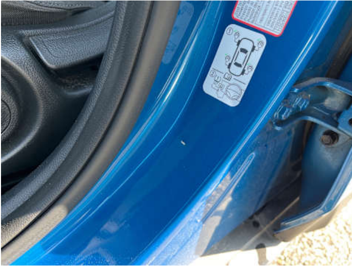
Schweller links (Kratzer, Delle)
