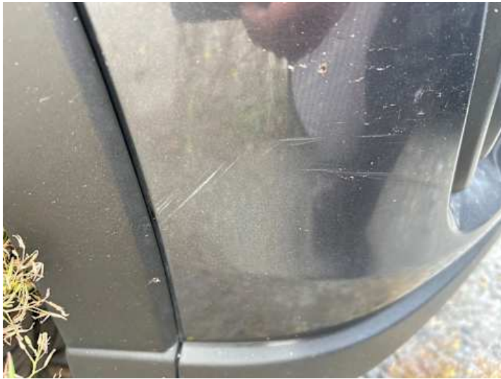
Stoßstange vorne (Kratzer, Lackschaden)
