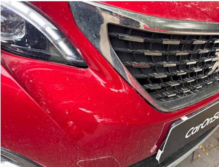
Stoßstange vorne (Spaltmaße ungenau)
