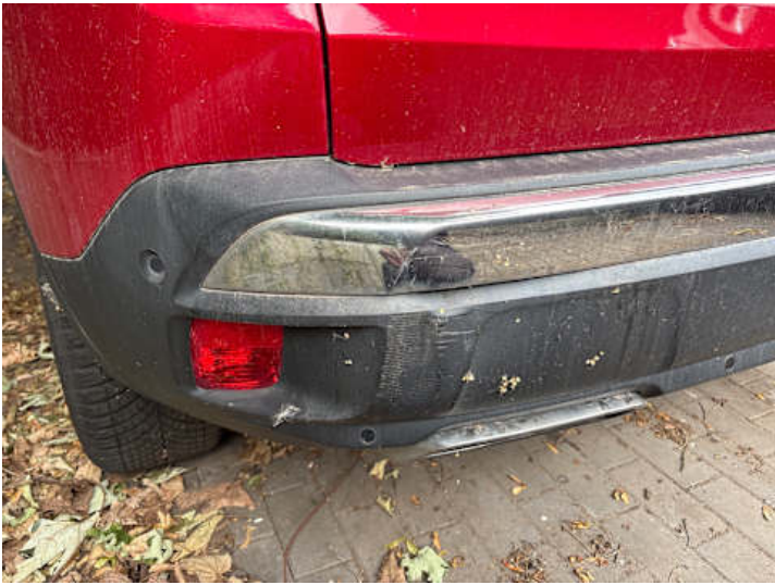
Stoßstange hinten (Kratzer)
