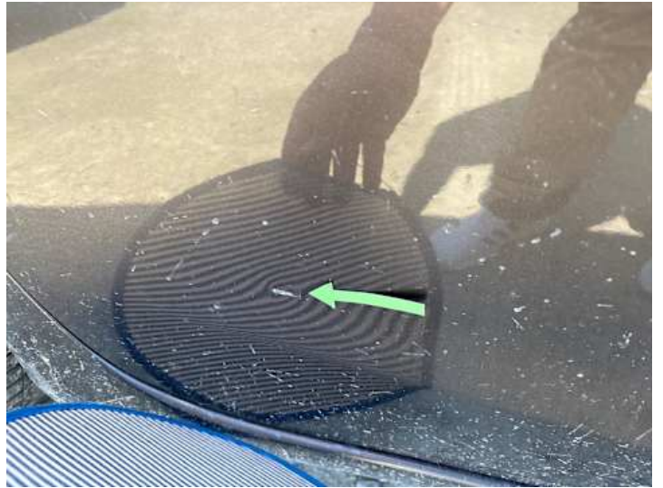
Türe hinten rechts (Kratzer, Delle)
