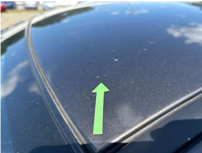
Dach (Steinschlag, Lackschaden, Rost)
