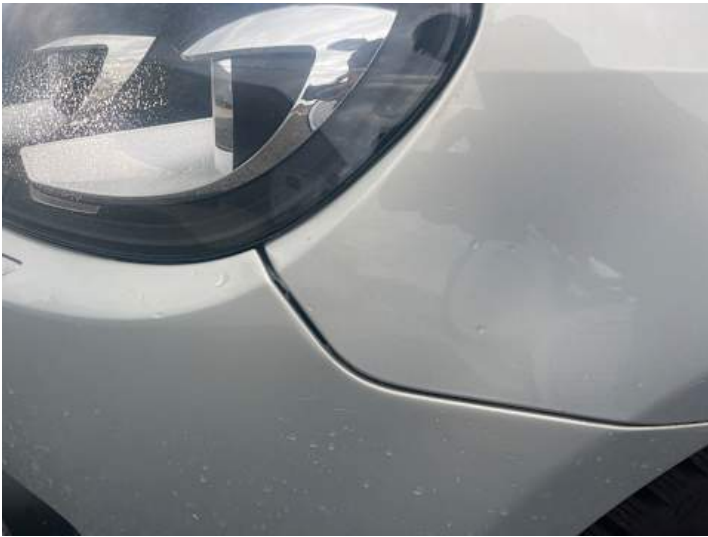
Stoßstange vorne (Spaltmaße ungenau)
