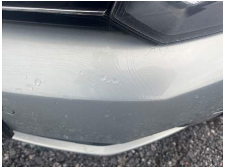
Stoßstange vorne (Riss/Bruch)
