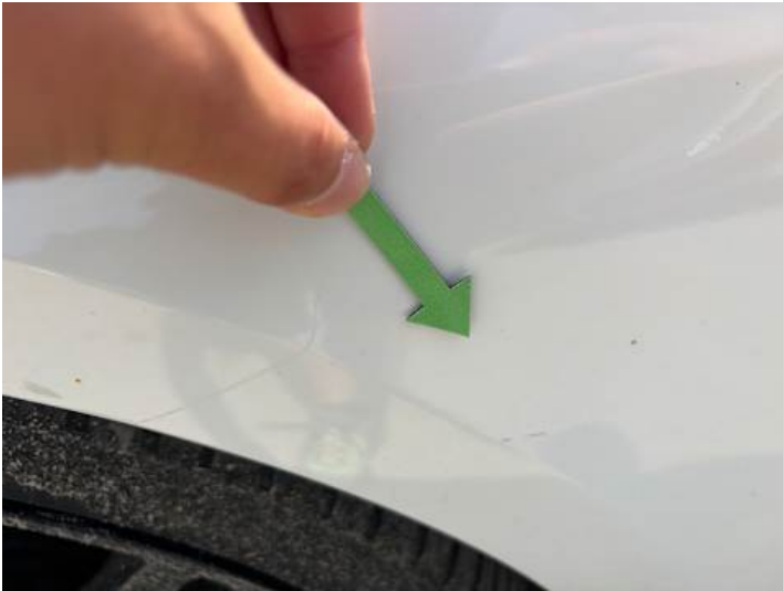
Kotflügel vorne links (Kratzer)
