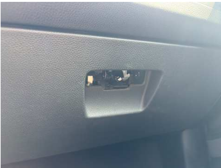
Innenraum (Ohne Funktion, Riss/Bruch)
