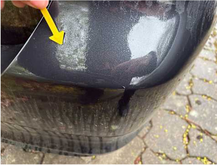
Stoßstange hinten (Delle, Verformung, Lackschaden)
