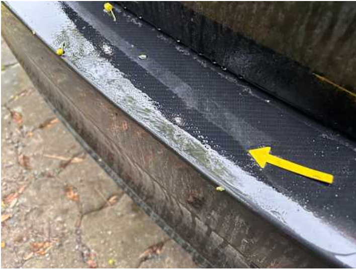
Stoßstange hinten (Delle, Verformung, Lackschaden)
