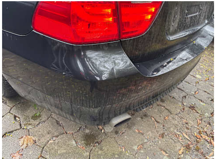
Stoßstange hinten (Delle, Verformung, Lackschaden)
