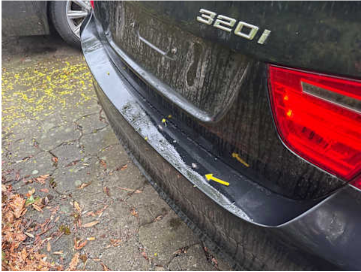
Stoßstange hinten (Delle, Verformung, Lackschaden)
