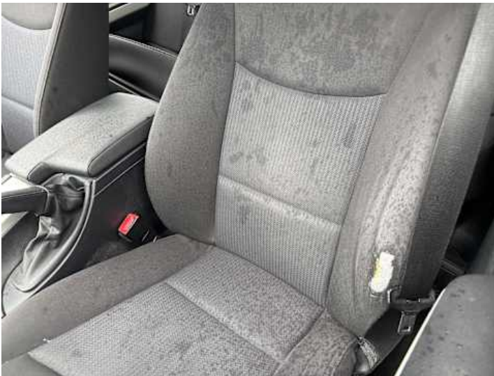
Innenraum (Verschleiß, Riss/Bruch)
