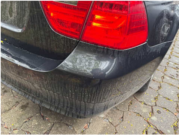
Stoßstange hinten (Delle, Verformung, Lackschaden)
