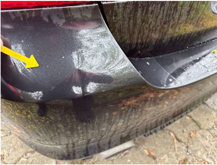
Stoßstange hinten (Delle, Verformung, Lackschaden)
