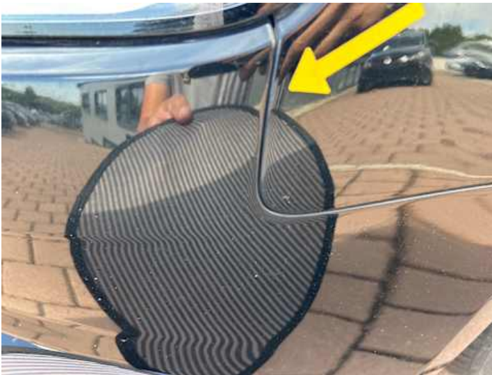
Stoßstange vorne (Unsachgemäß instand gesetzt, Verformung)
