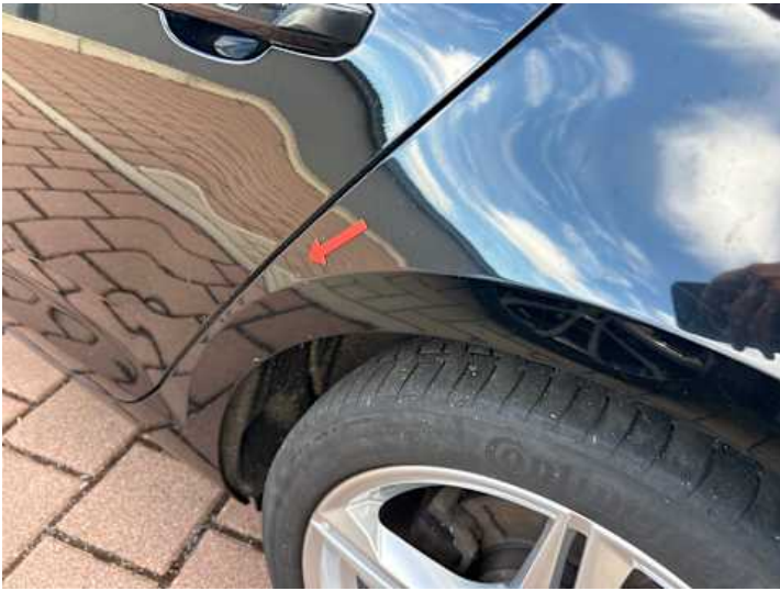
Seitenteil hinten links (Rost)
