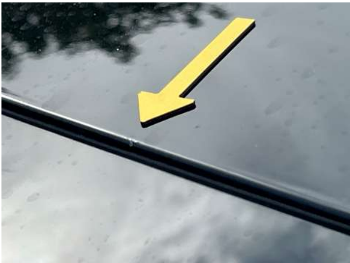
Dach (Rost, Steinschlag)
