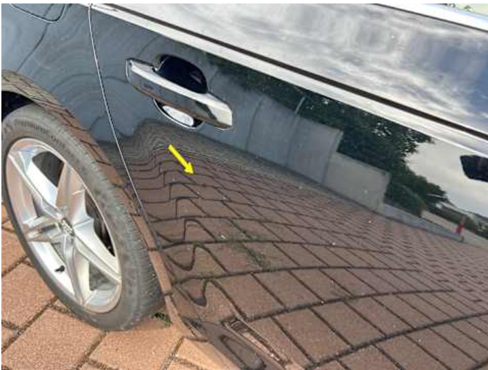
Türe hinten rechts (Delle)
