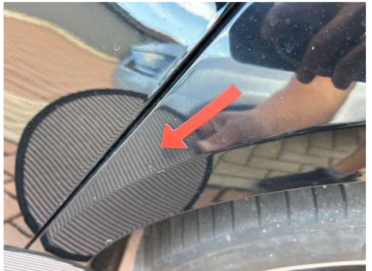
Seitenteil hinten links (Rost)
