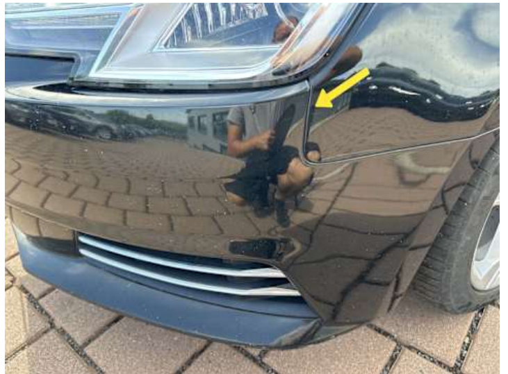
Stoßstange vorne (Unsachgemäß instand gesetzt, Verformung)
