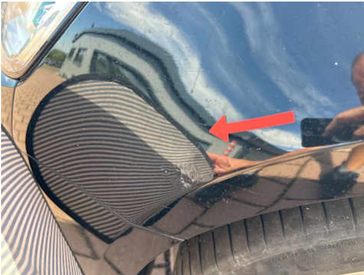
Kotflügel vorne links (Delle, Rost, Unsachgemäß instand gesetzt)
