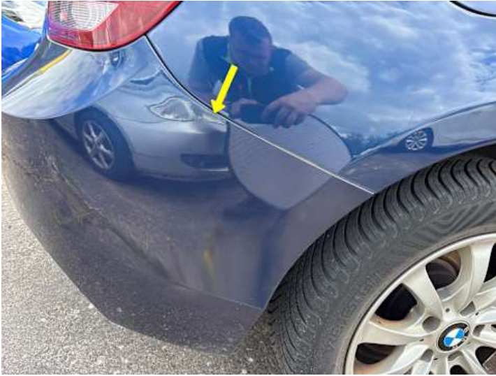
Stoßstange hinten (Unsachgemäß instand gesetzt)
