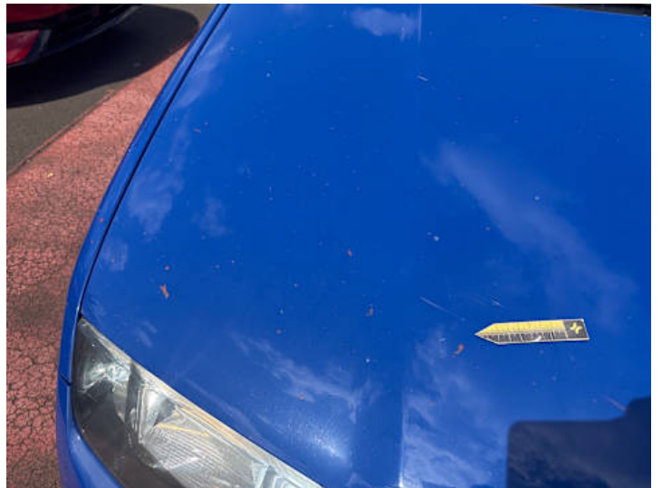
Motorhaube (Delle, Unsachgemäß instand gesetzt)
