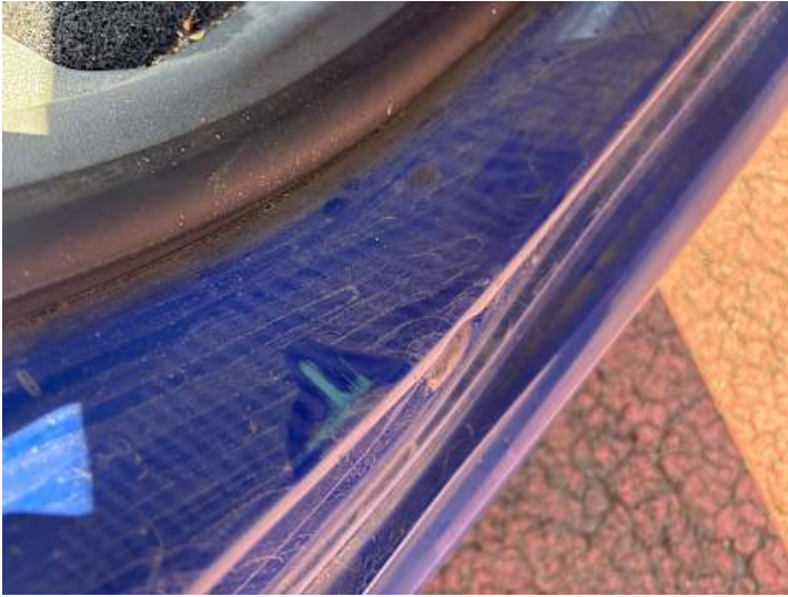
Schweller rechts (Delle, Kratzer)
