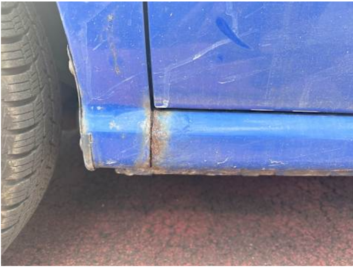
Schweller links (Rost)
