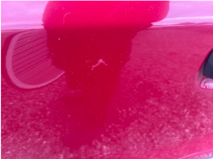
Türe hinten links (Lackschaden, Unsachgemäß instand gesetzt)
