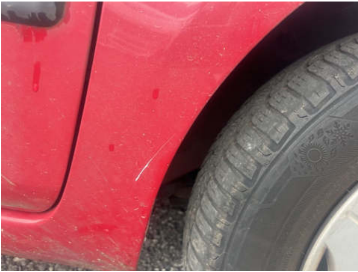
Kotflügel vorne rechts (Kratzer, Lackschaden)
