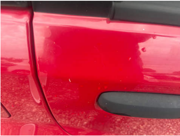
Türe hinten rechts (Kratzer, Lackschaden)
