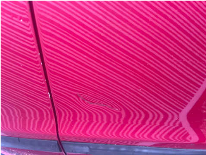
Türe hinten links (Delle)
