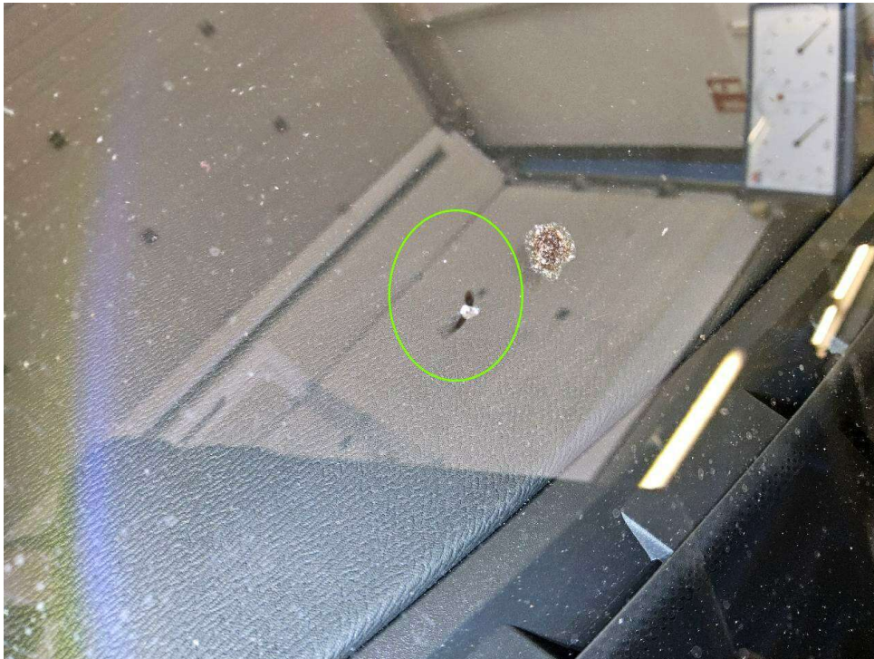
Bild 9 : Frontscheibe Steinschlag mit Rissbildung
