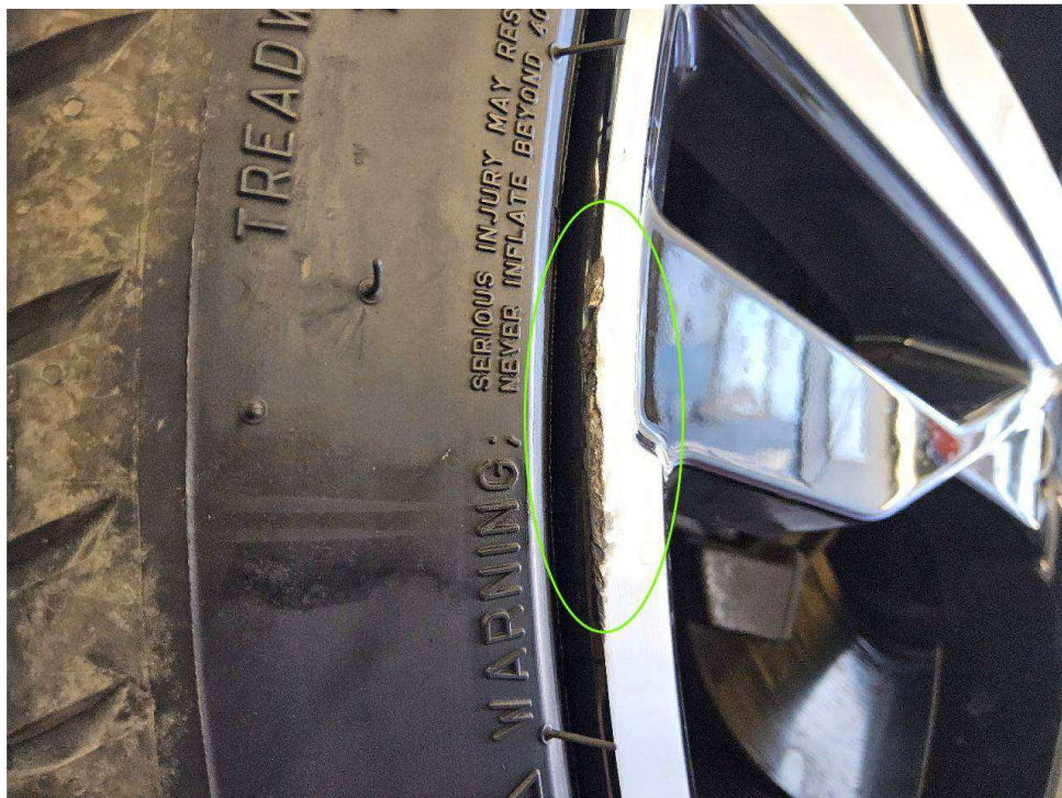
Bild 25 : Felge glanzgedreht vorne links mehrfach verschrammt
