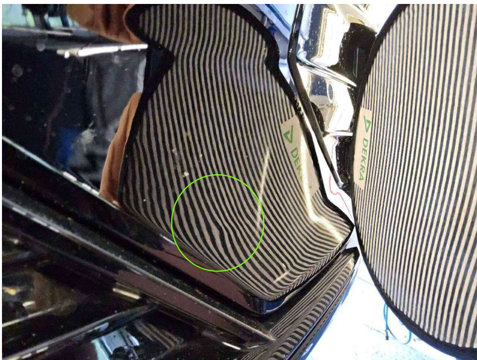
Bild 18 : Stoßfänger vorne unsachgemäß instandgesetzt und nachlackiert, Verwerfungen und Lackeinschlüsse ersichtlich
