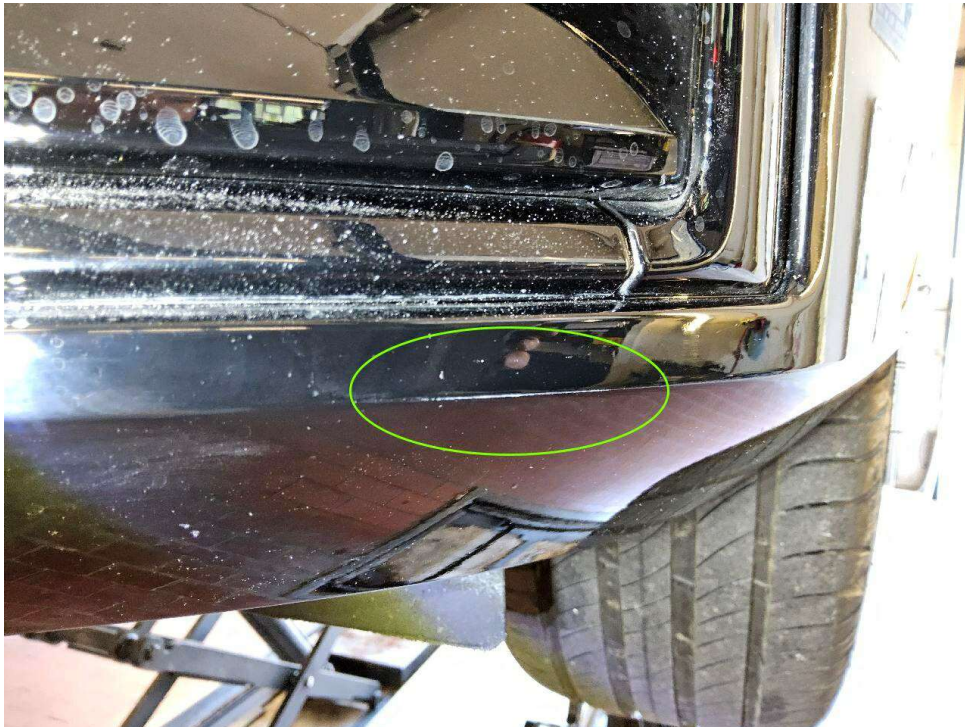
Bild 17 : Stoßfänger vorne unsachgemäß instandgesetzt und nachlackiert, Verwerfungen und Lackeinschlüsse ersichtlich
