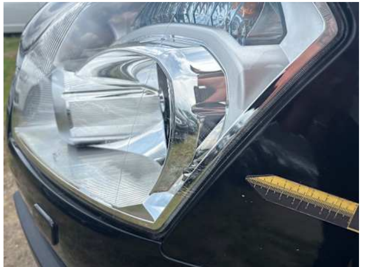
Scheinwerfer (links) (Anderer Schaden): Spröde
