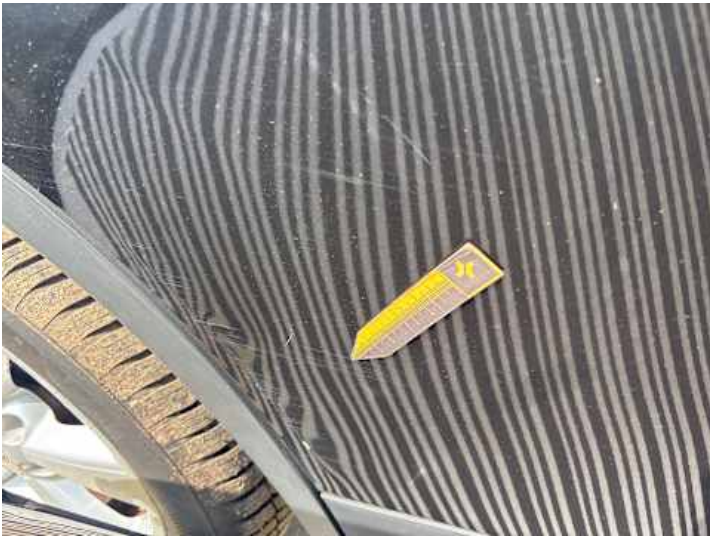
Türe hinten rechts (Verformung)
