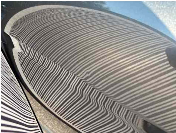
Türe hinten rechts (Delle, Kratzer)
