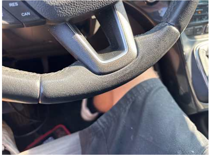
Innenraum (Verschleiß, Verschmutzung)
