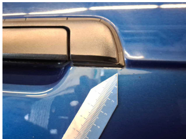
Beschädigung 17: Tür vorn rechts: Tür (Dellen und Lackabplatzungen) - instandsetzen und lackieren
