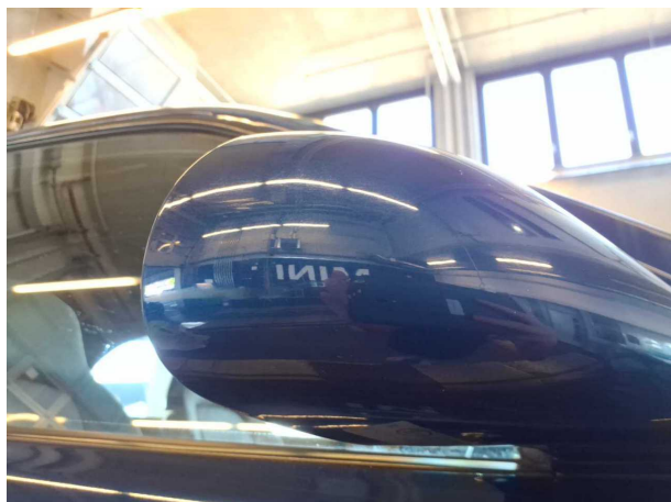
Beschädigung 3: Außenspiegel rechts: Abdeckkappe - Kratzer - lackieren
