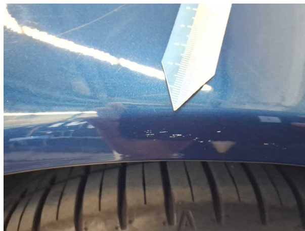
Beschädigung 15: Kotflügel rechts: Kotflügel rechts - Kratze... lackieren
