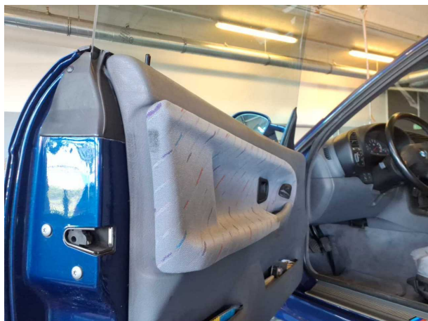
Beschädigung 1: Verkleidungen/Abdeckungen: Türverkleidung vorn links - lose - de-/montieren
