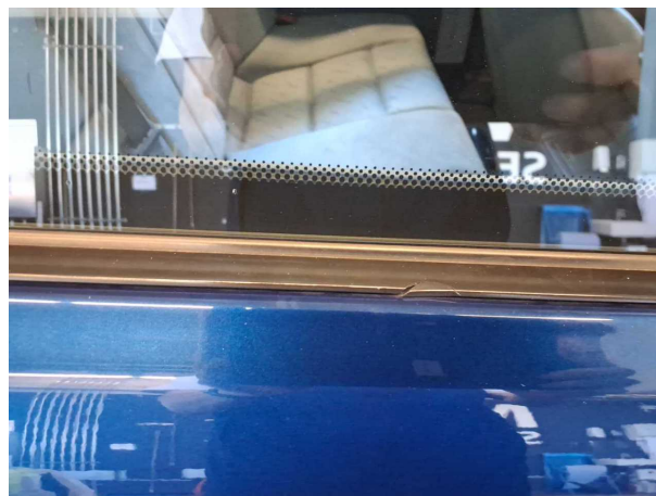
Beschädigung 4: Verglasung: Dreieckscheibe rechts (Gummi) - beschädigt - erneuern
