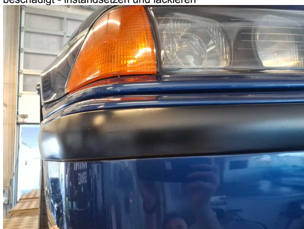
Beschädigung 18: Stossfänger vorn: Stossfänger vorn - beschädigt - instandsetzen und lackieren
