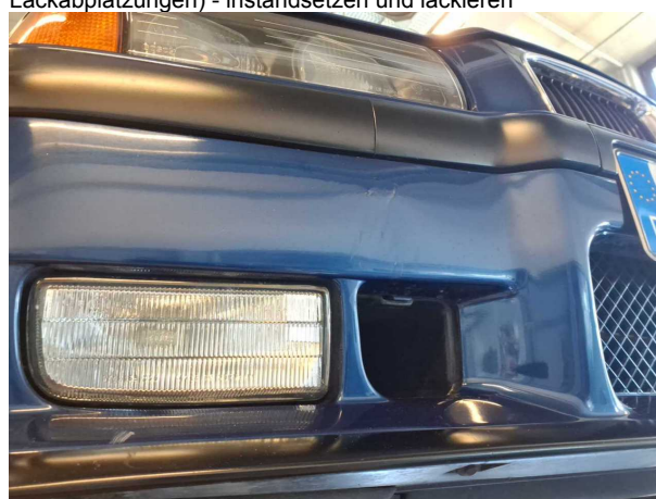
Beschädigung 18: Stossfänger vorn: Stossfänger vorn - beschädigt - instandsetzen und lackieren
