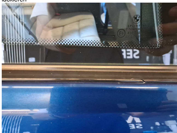
Beschädigung 4: Verglasung: Dreieckscheibe rechts (Gummi) - beschädigt - erneuern
