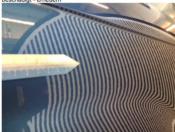
Beschädigung 5: Seitenwand rechts: Seitenwand - Delle(n)
