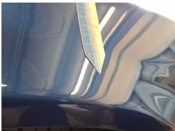
Beschädigung 15: Kotflügel rechts: Kotflügel rechts - Kratzer - lackieren
