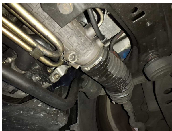
Beschädigung 12: Lenkanlage: Lenkanlage - undicht - Diagnose durchführen
