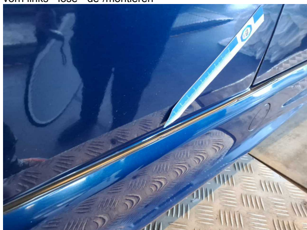
Beschädigung 2: Schweller links: Schweller (Gummidichtung eingeklemmt) - einstellen/justieren
