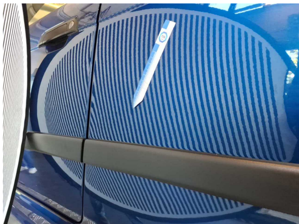
Beschädigung 9: Seitenwand links: Seitenwand (Erhöhte Dellen Anzahl) - Delle(n) - sanft instandsetzen
