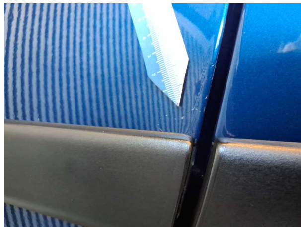
Beschädigung 16: Tür vorn links: Tür - Delle / Lackschaden - instandsetzen und lackieren
