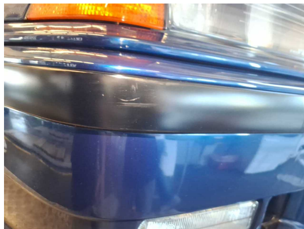
Beschädigung 6: Stossfänger vorn: Stossfänger vorn (unlackiert) (Blende) - beschädigt
