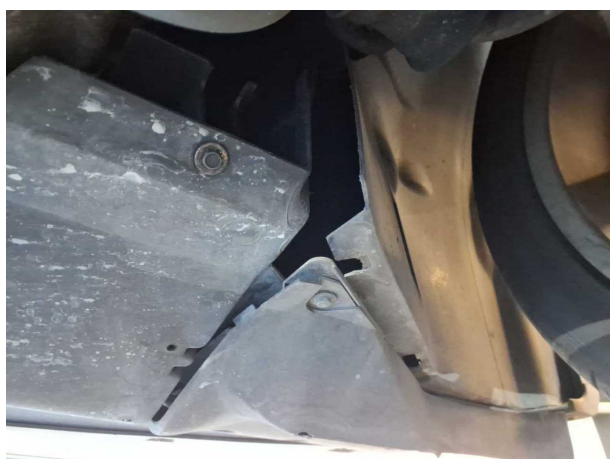
Beschädigung 11: Karosserie: Unterboden - beschädigt
