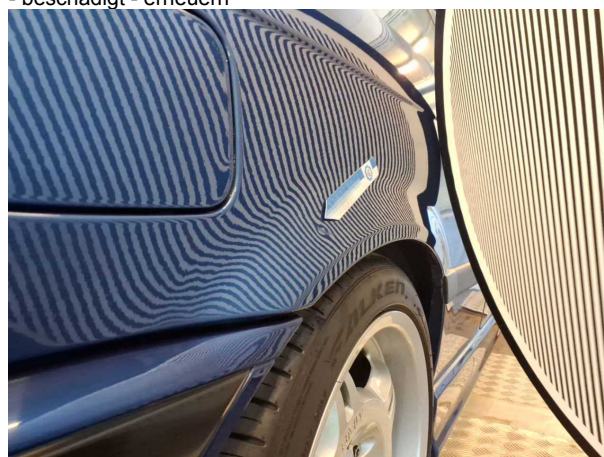
Beschädigung 5: Seitenwand rechts: Seitenwand - Delle(n)
