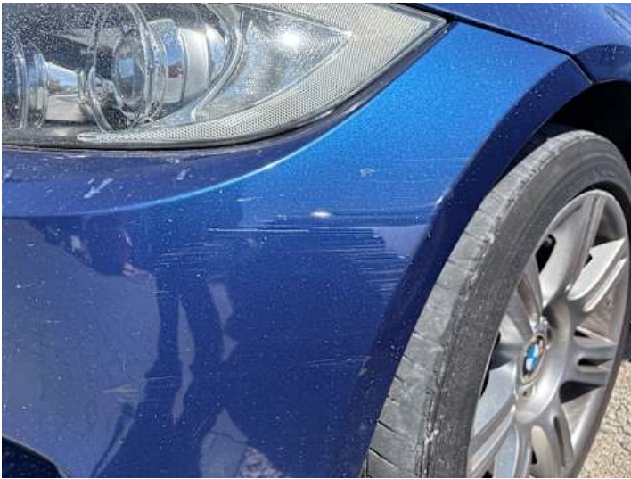
Stoßstange vorne (Lackschaden)
