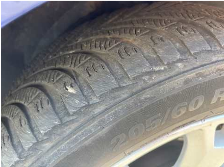
Rad (Ungleichmäßig abgefahren)
