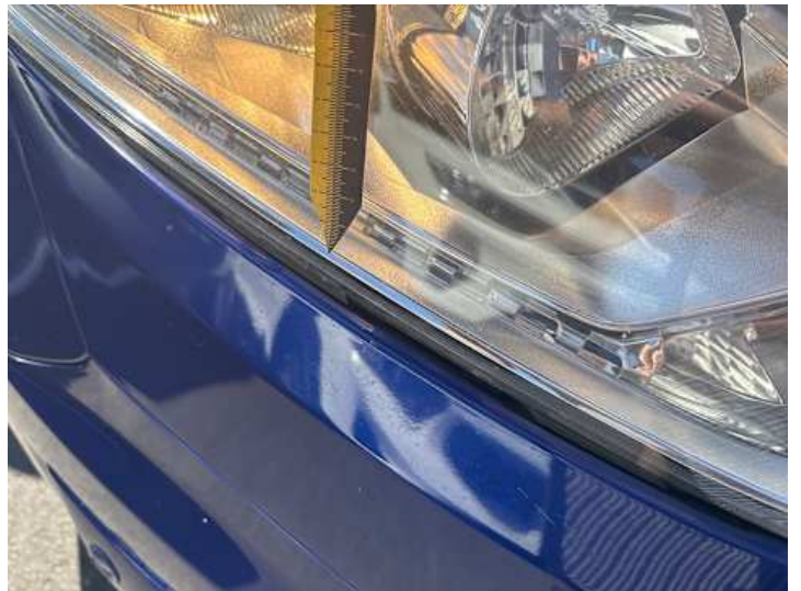
Stoßstange vorne (Spaltmaße ungenau)
