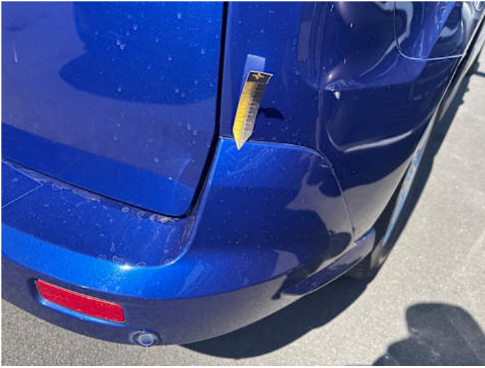
Stoßstange hinten (Unsachgemäß instand gesetzt)
