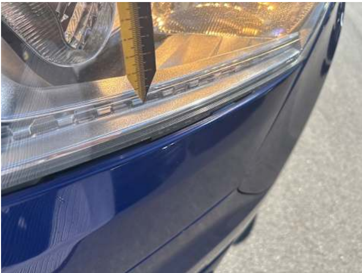
Stoßstange vorne (Spaltmaße ungenau)
