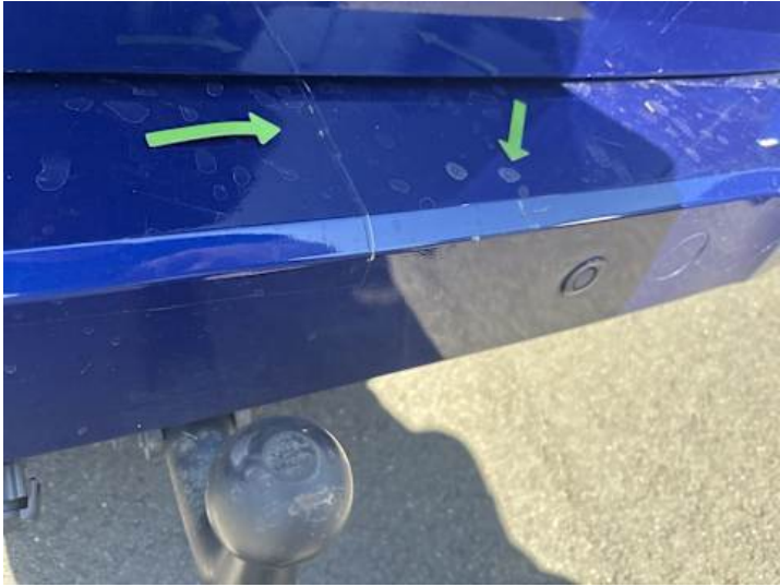
Stoßstange hinten (Lackschaden, Kratzer)
