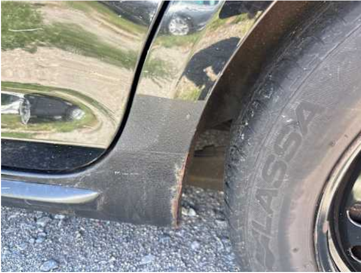
Seitenteil hinten links (Rost)
