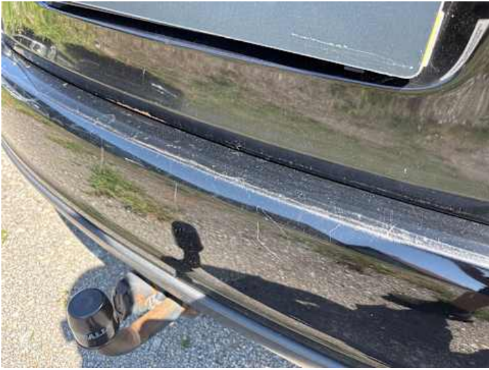
Stoßstange hinten (Kratzer)
