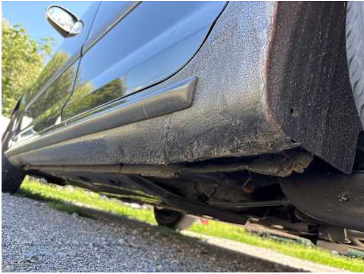
Schweller links (Rost)
