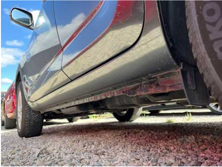
Schweller links (Rost, Verformung)
