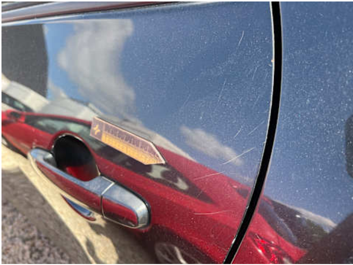
Türe hinten links (Kratzer, Rost)
