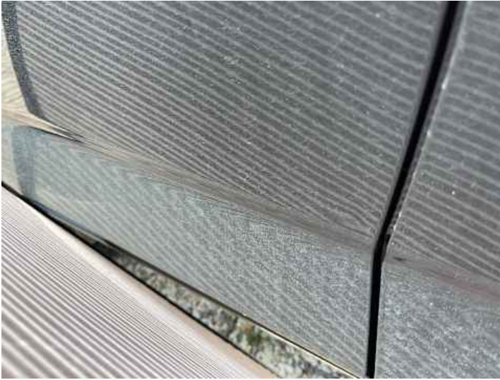
Türe hinten rechts (Delle)
