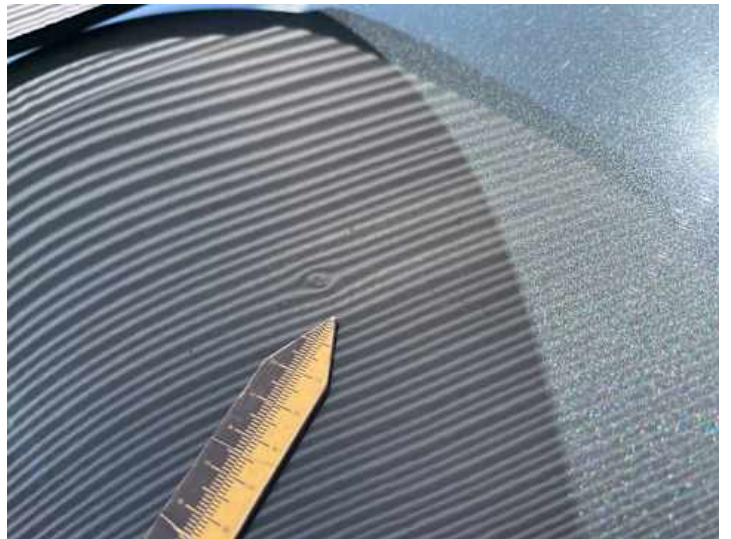
Motorhaube (Steinschlag, Delle, Rost)
