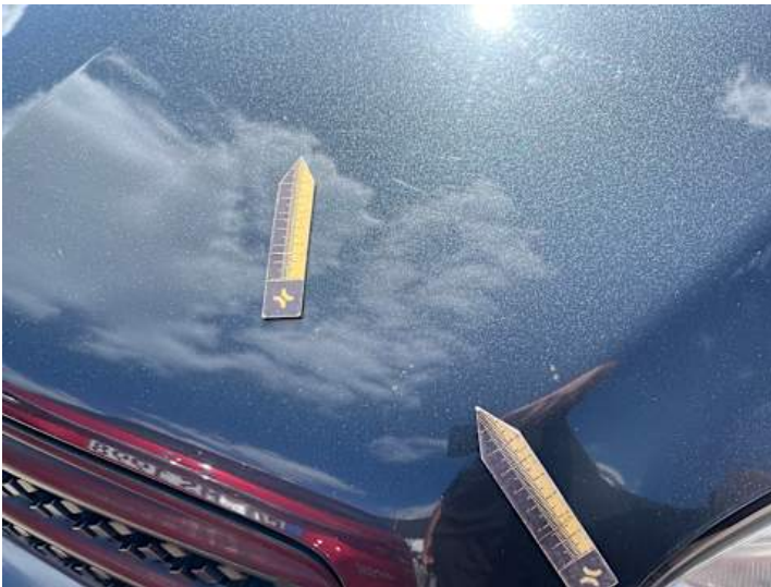
Motorhaube (Steinschlag, Delle, Rost)
