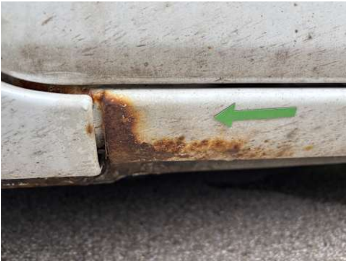
Schweller links (Rost)
