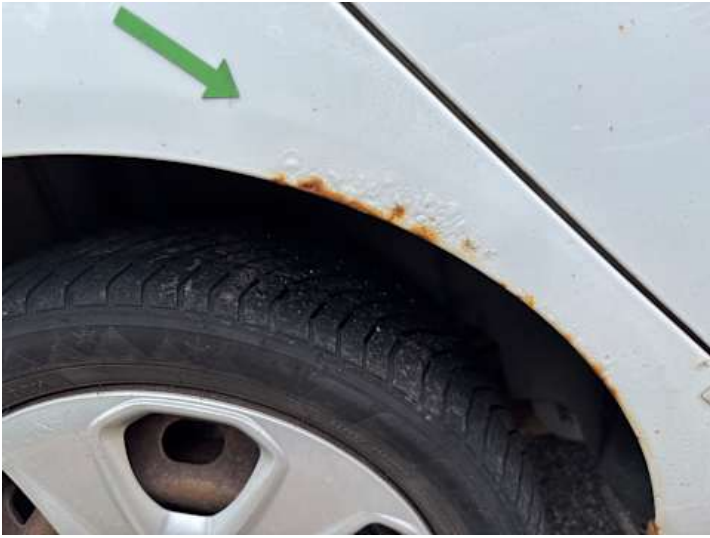
Seitenteil hinten rechts (Rost)
