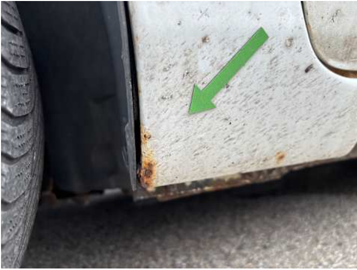
Kotflügel vorne links (Rost)
