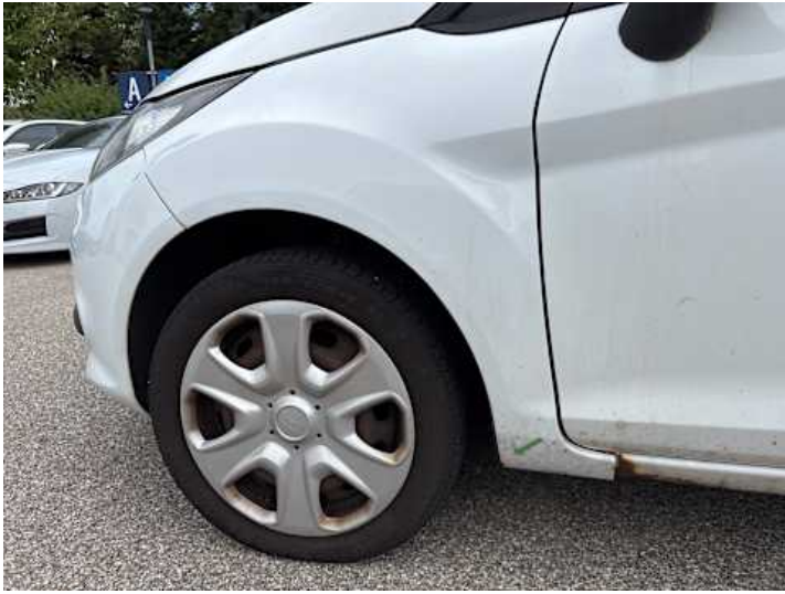
Kotflügel vorne links (Rost)
