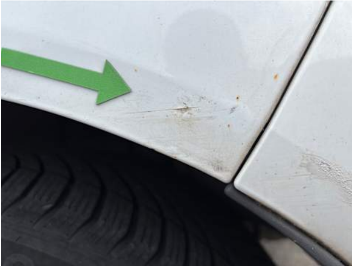
Seitenteil hinten links (Rost)
