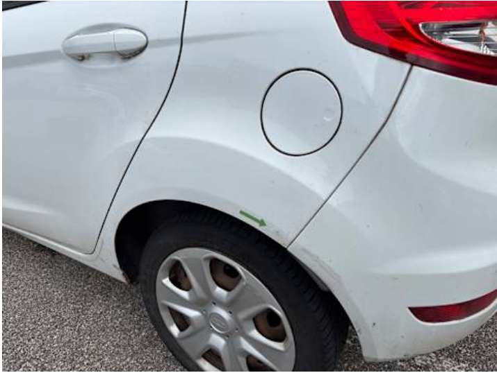
Seitenteil hinten links (Rost)
