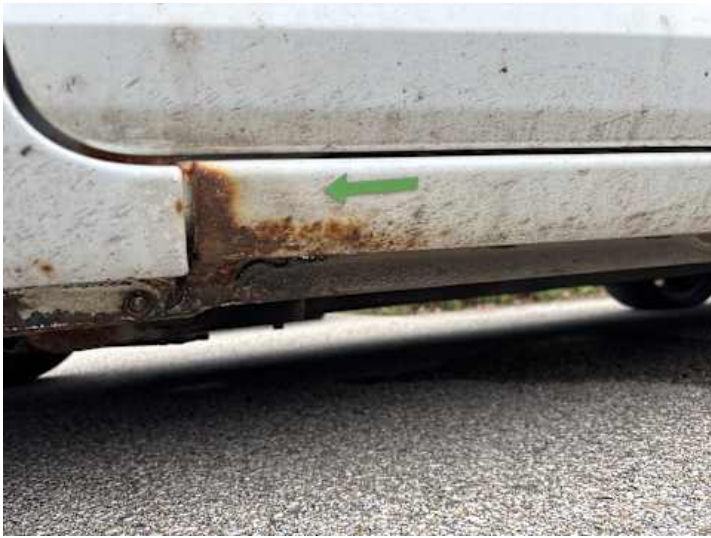
Schweller links (Rost)
