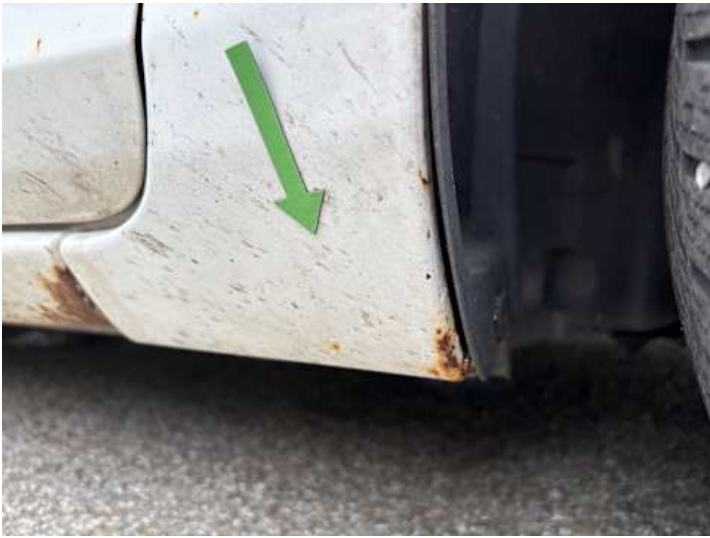
Kotflügel vorne rechts (Rost)
