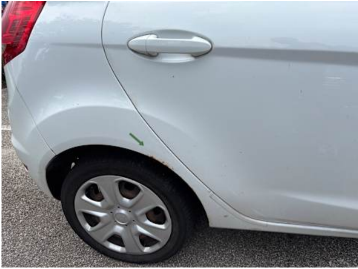
Seitenteil hinten rechts (Rost)
