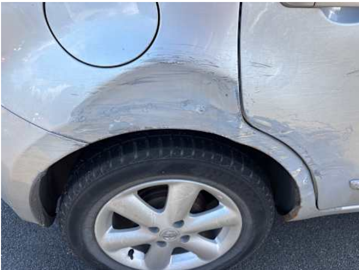
Seitenteil hinten rechts (Unsachgemäß instand gesetzt, Kratzer, Verformung)
