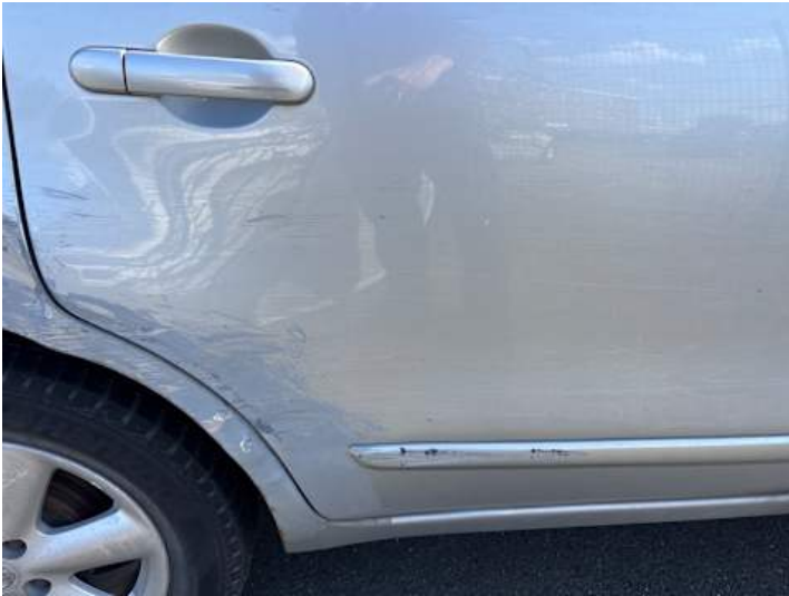
Türe hinten rechts (Kratzer, Verformung, Unsachgemäß instand gesetzt)
