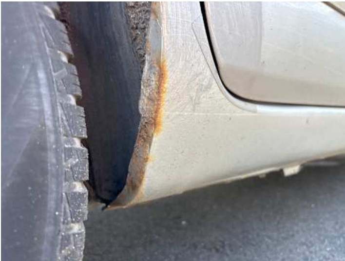
Schweller rechts (Rost)
