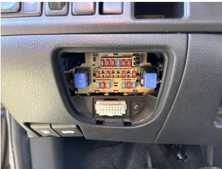
Innenraum (Anderer Schaden): Abdeckung fehlt
