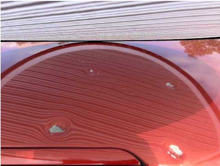
Dach (Delle, Anderer Schaden): Vandalismusschaden
