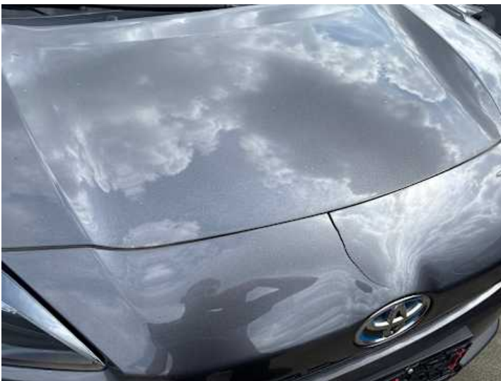
Motorhaube (Spaltmaße ungenau)
