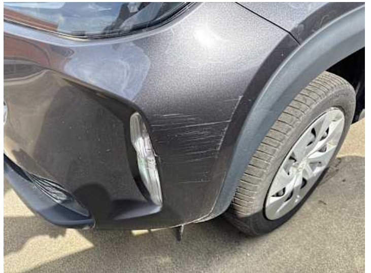
Stoßstange vorne (Kratzer, Riss/Bruch)
