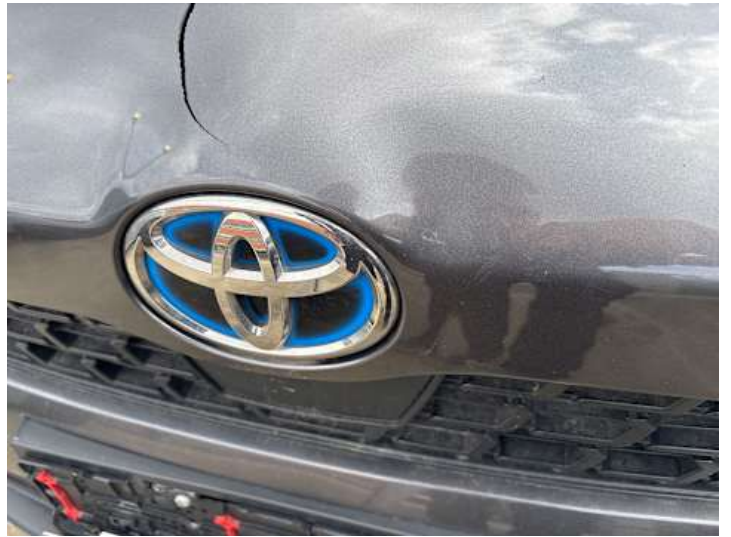
Stoßstange vorne (Kratzer, Riss/Bruch)
