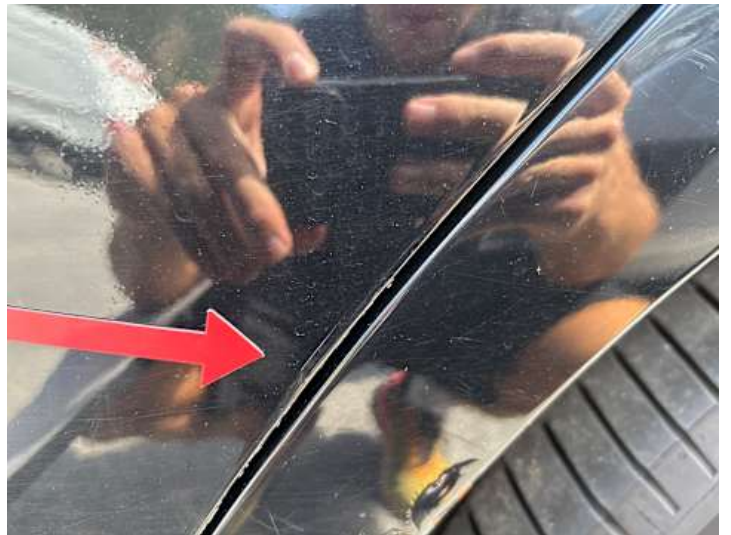
Türe hinten links (Unsachgemäß instand gesetzt)
