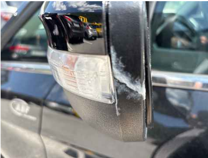
Fahrertür (Unsachgemäß instand gesetzt, Riss/Bruch)
