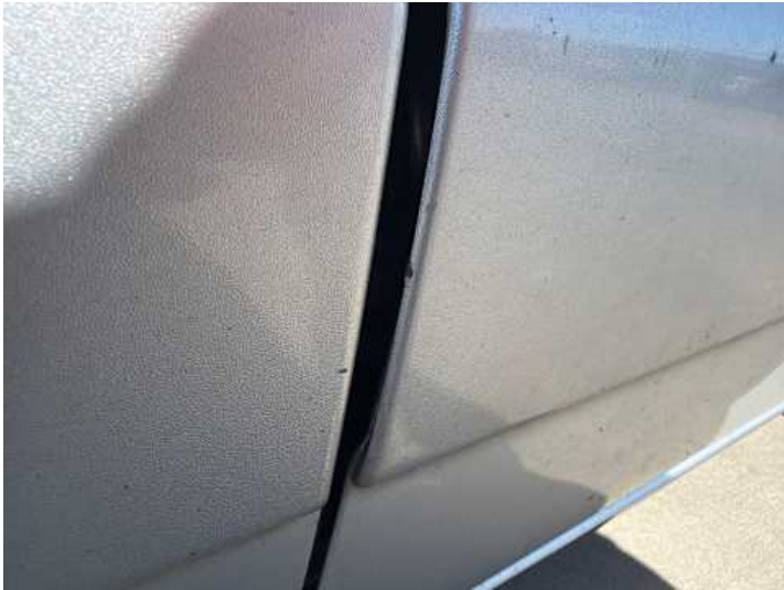
Beifahrtür (Kratzer, Lackschaden)
