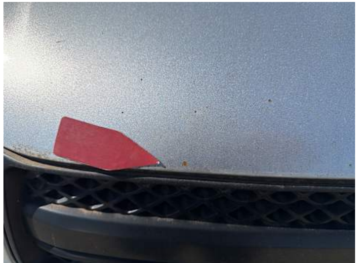
Motorhaube (Steinschlag, Rost)
