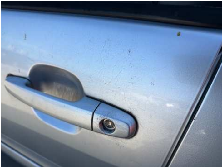
Fahrtür (Kratzer, Delle)
