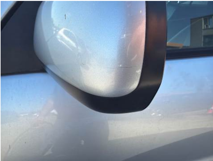
Fahrtür (Kratzer, Delle)
