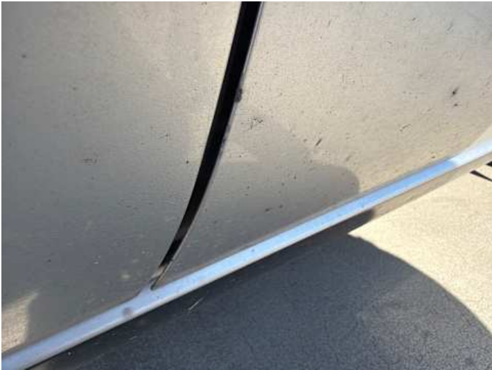
Beifahrtür (Kratzer, Lackschaden)
