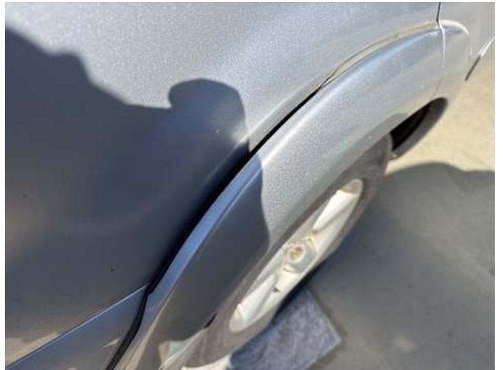
Seitenteil hinten rechts (Unsachgemäß instand gesetzt)
