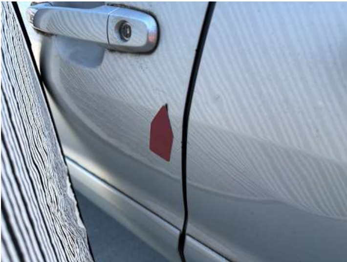
Fahrtür (Kratzer, Delle)
