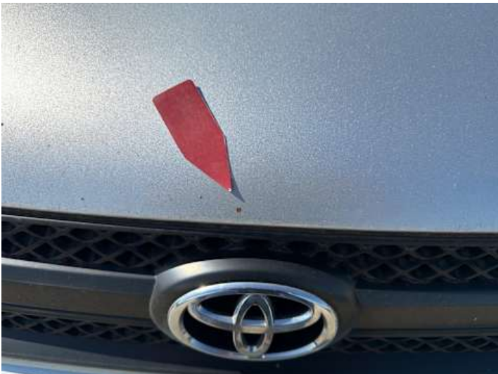
Motorhaube (Steinschlag, Rost)
