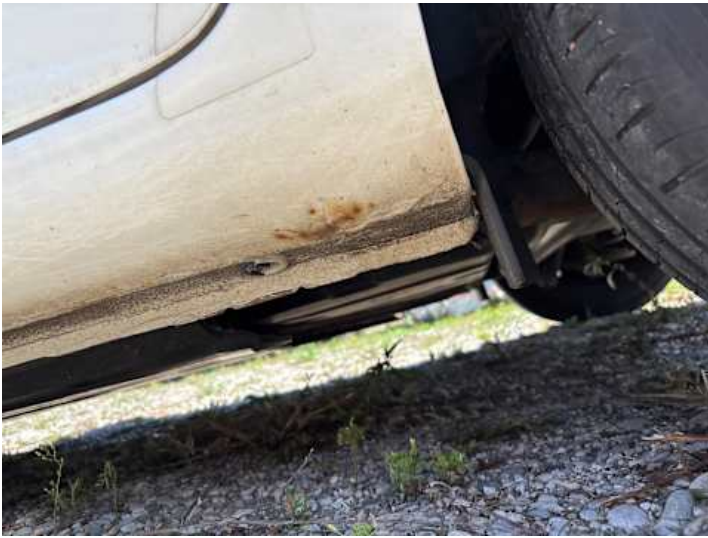
Schweller links (Rost)
