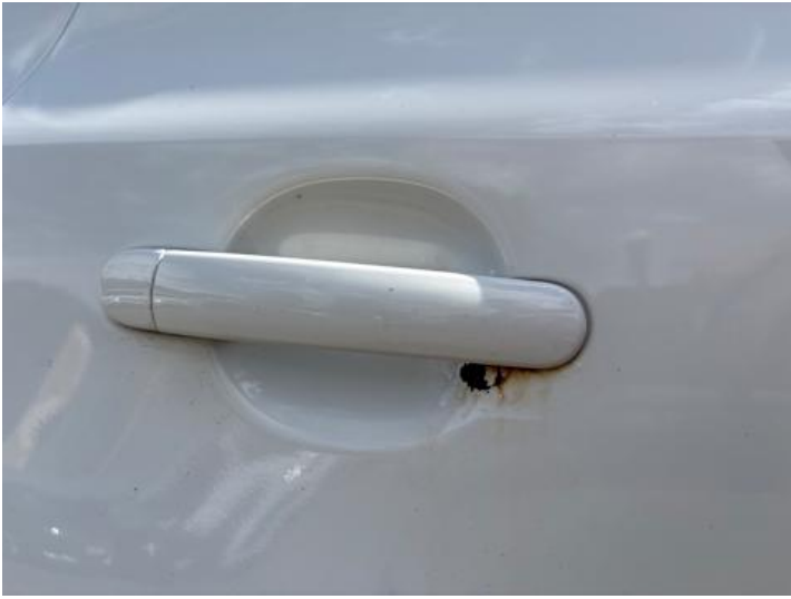
Türe hinten rechts (Rost)
