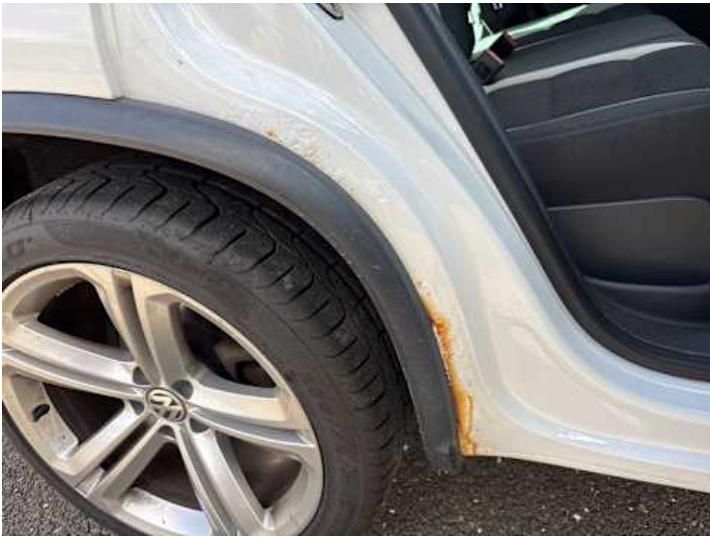
Seitenteil hinten rechts (Rost)
