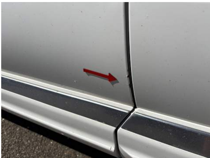
Fahrtür (Kratzer, Rost, Lackschaden)
