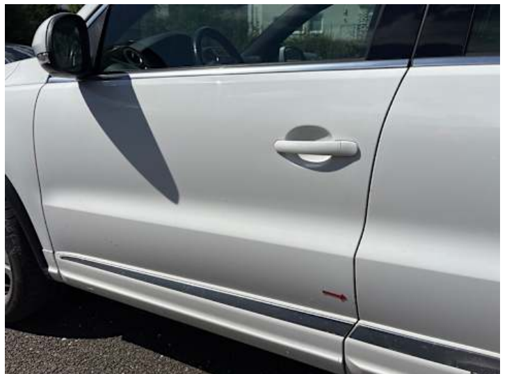
Fahrtür (Kratzer, Rost, Lackschaden)
