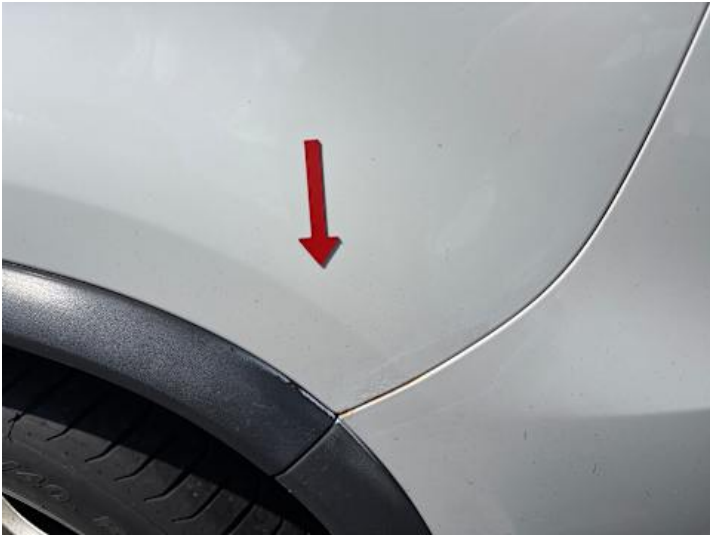
Seitenteil hinten links (Rost)
