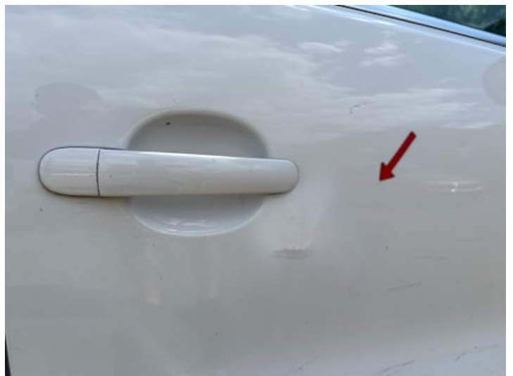
Beifahrtür (Verformung, Kratzer, Lackschaden)
