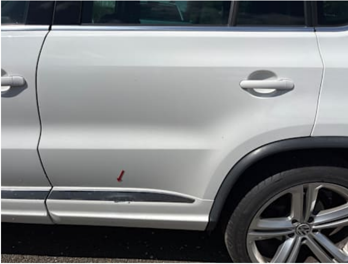
Türe hinten links (Kratzer, Lackschaden)
