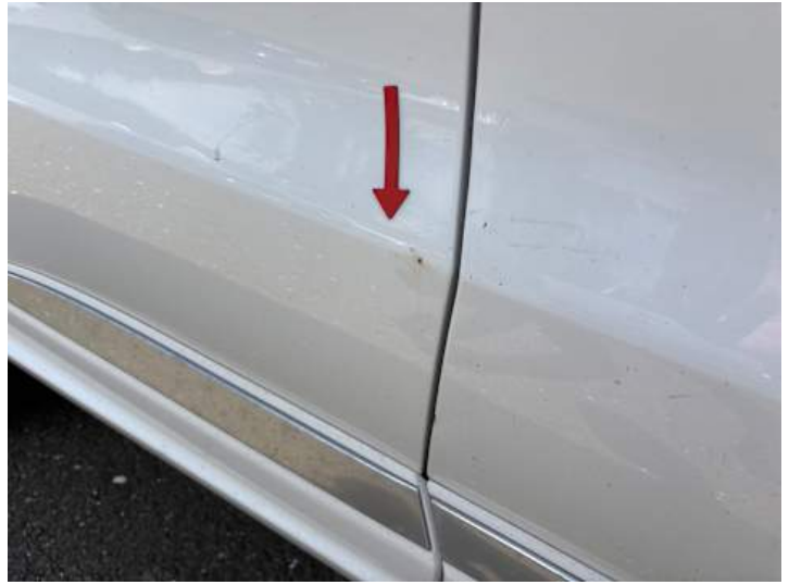
Türe hinten rechts (Rost)
