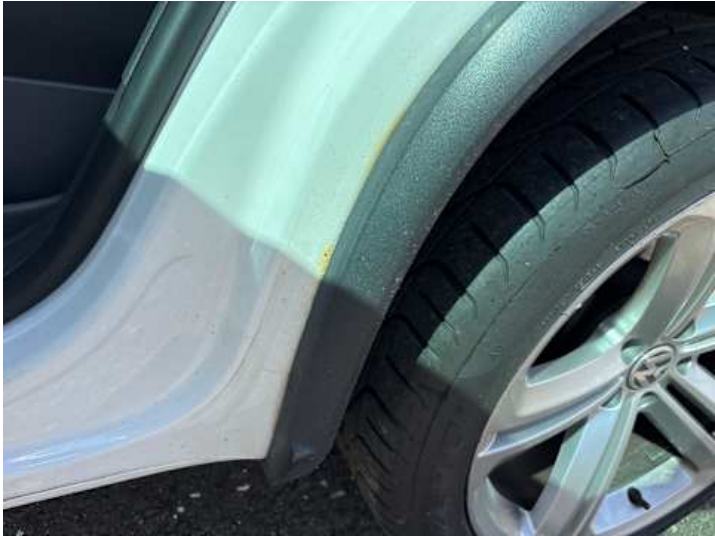
Seitenteil hinten links (Rost)
