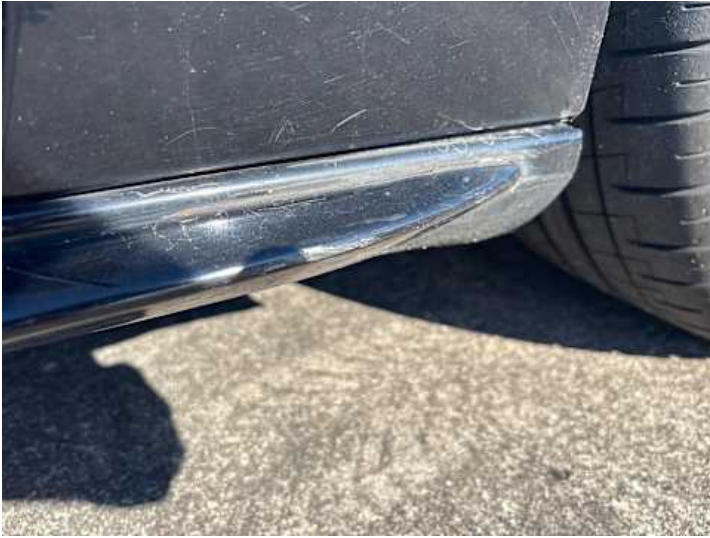
Schweller rechts (Kratzer, Spaltmaße ungenau)
