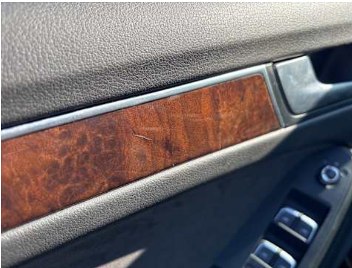
Innenraum (Kratzer, Riss/Bruch)
