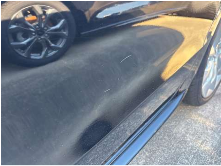
Türe hinten links (Kratzer)
