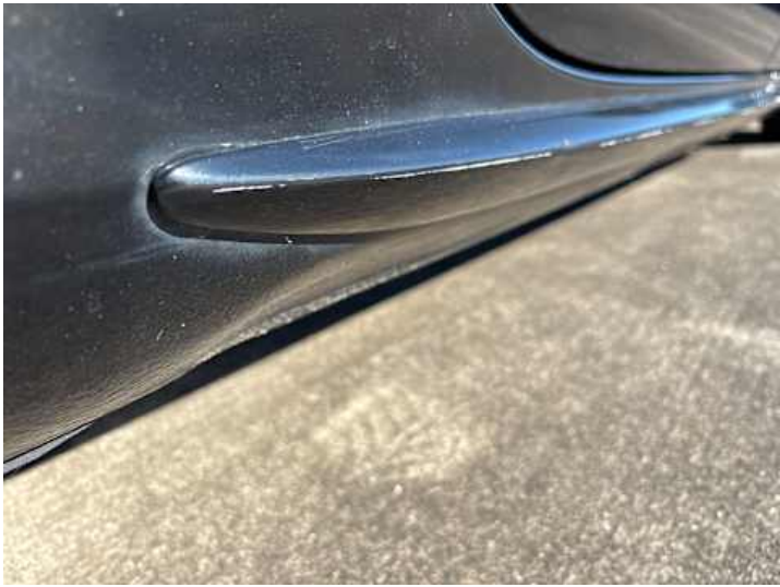
Schweller rechts (Kratzer, Spaltmaße ungenau)
