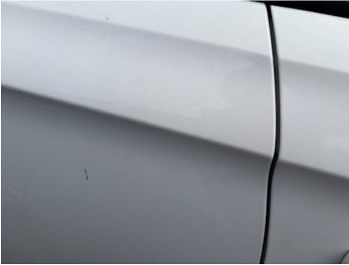
Türe hinten rechts (Lackschaden, Kratzer)
