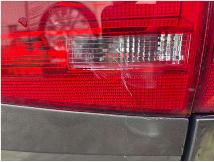
Rücklicht (rechts) (Riss/Bruch)
