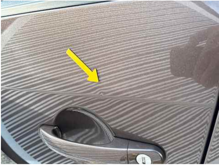
Fahrtür (Kratzer, Delle)
