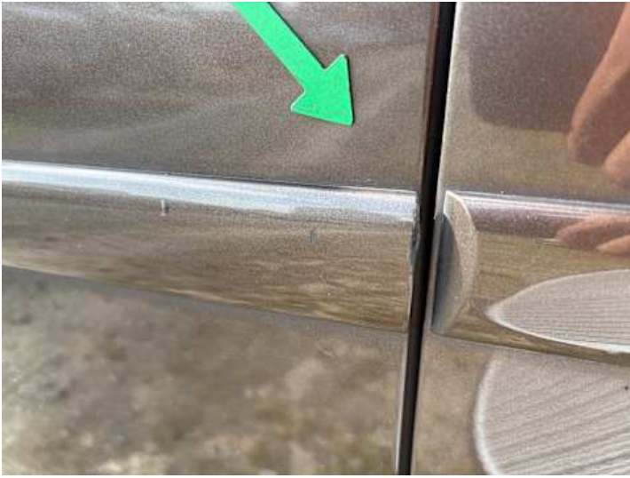
Fahrtür (Kratzer, Delle)
