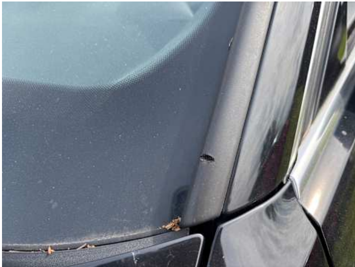
Windschutzscheibe (Anderer Schaden): Leiste beschädigt
