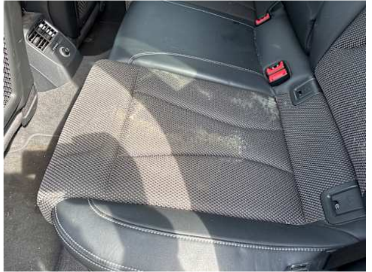
Innenraum (Anderer Schaden): Schimmel
