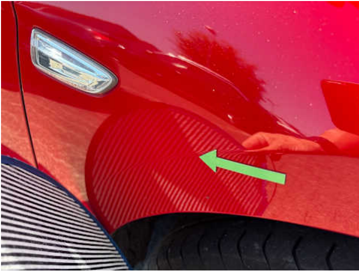
Kotflügel vorne rechts (Delle, Steinschlag)
