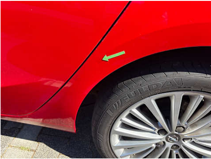
Seitenteil hinten links (Kratzer, Delle)
