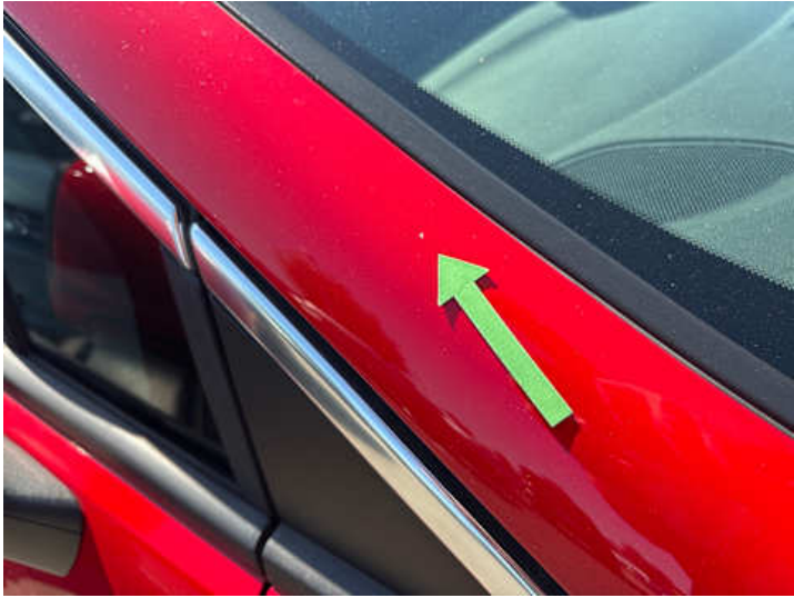
Kotflügel vorne rechts (Delle, Steinschlag)
