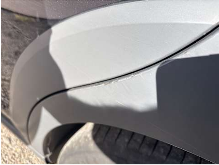
Seitenteil hinten links (Lackschaden)
