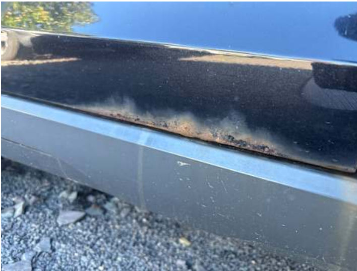
Türe hinten rechts (Rost)
