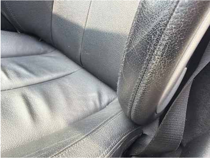
Innenraum (Kratzer, Verschleiß)
