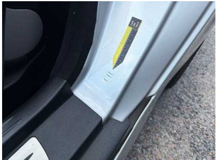
Schweller links (Kratzer)
