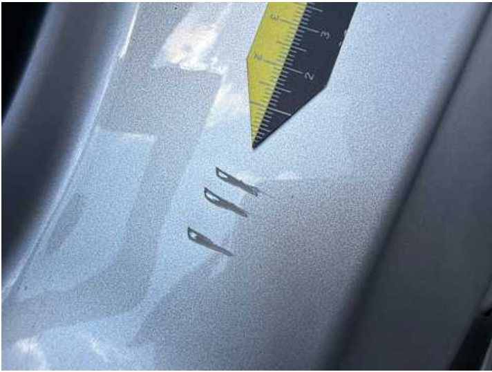
Schweller links (Kratzer)
