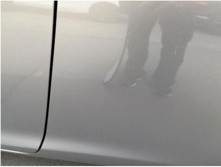
Seitenteil hinten links (Lackschaden, Kratzer)
