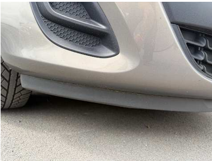
Stoßstange vorne (Lackschaden, Kratzer)
