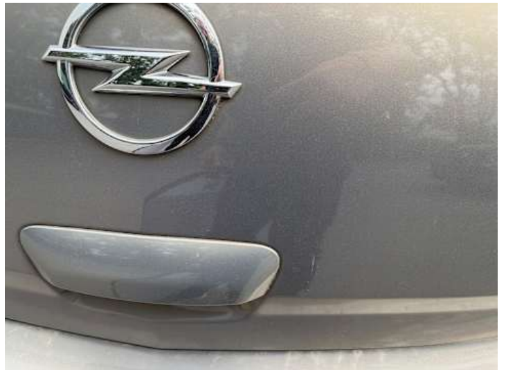
Heckklappe (Lackschaden, Kratzer)
