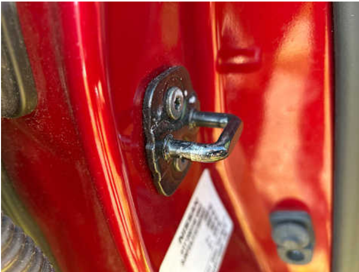
Beifahrertür (Anderer Schaden): Tür schließt schlecht
