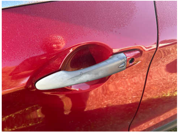
Fahrertür (Unsachgemäß instand gesetzt)
