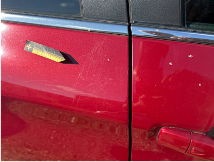
Türe hinten rechts (Kratzer)
