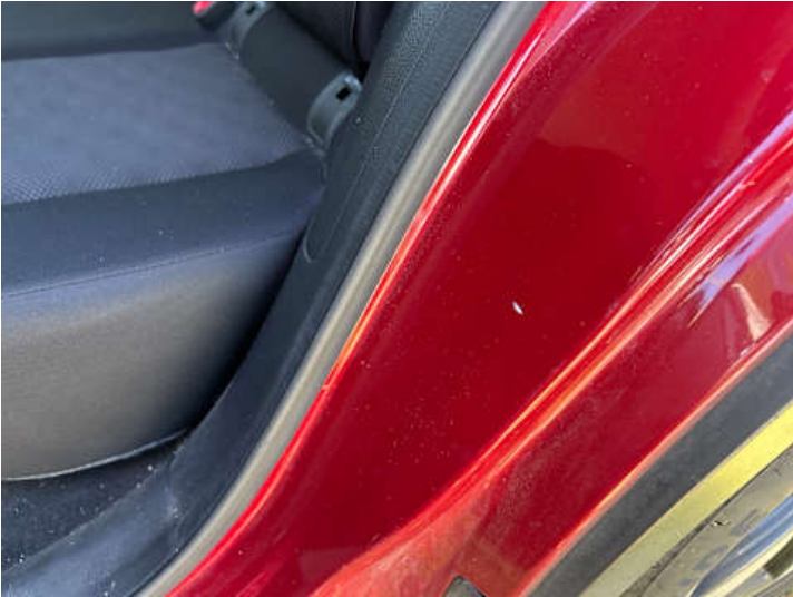
Schweller links (Kratzer)
