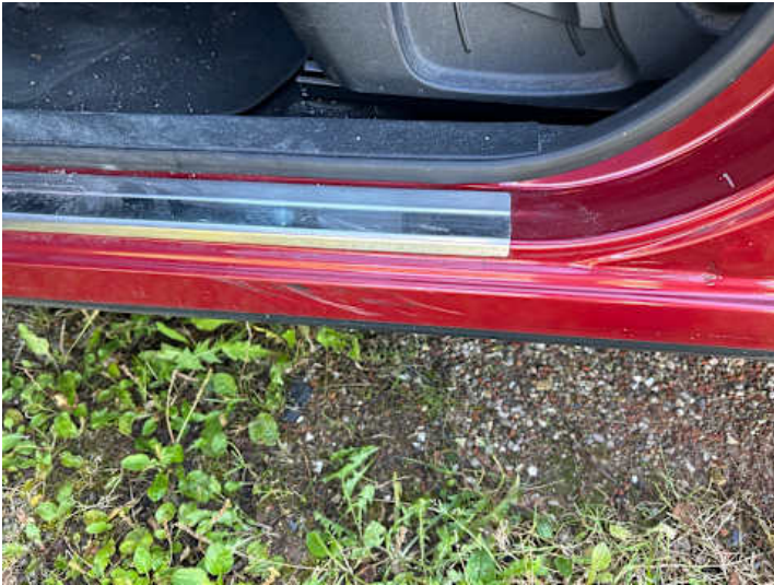
Schweller links (Kratzer)
