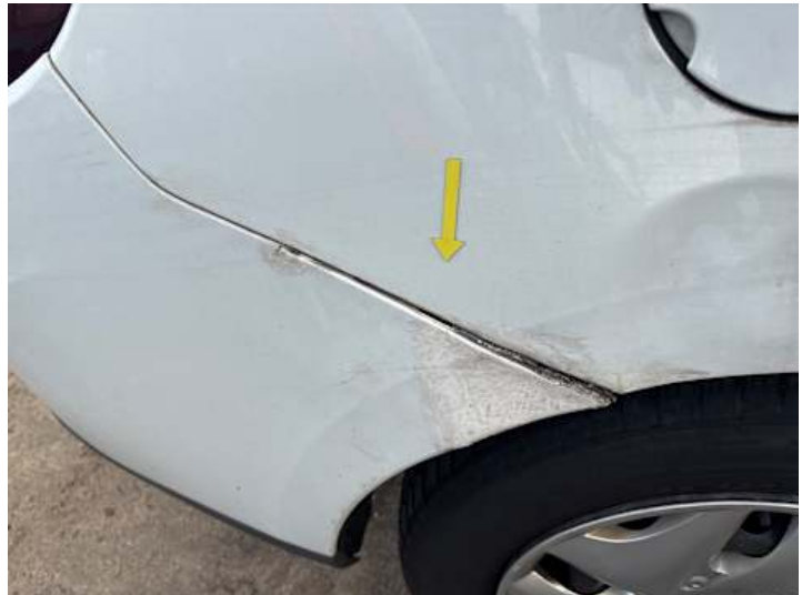
Stoßstange hinten (Kratzer, Verformung, Spaltmaße ungenau)
