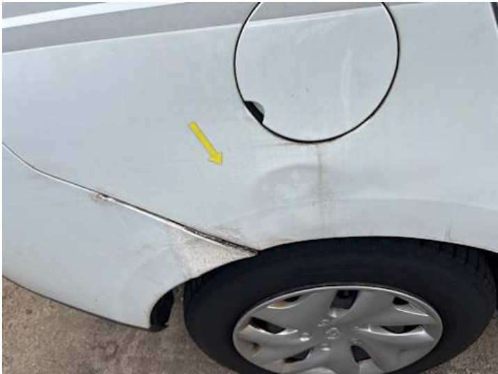
Seitenteil hinten rechts (Verformung, Kratzer)
