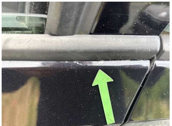
Fahrertür (Lackschaden, Unsachgemäß instand gesetzt)
