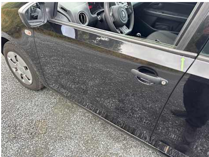
Fahrertür (Lackschaden, Unsachgemäß instand gesetzt)
