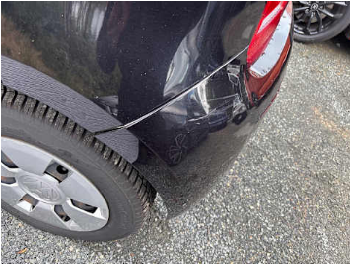
Stoßstange hinten (Riss/Bruch, Spaltmaße ungenau)
