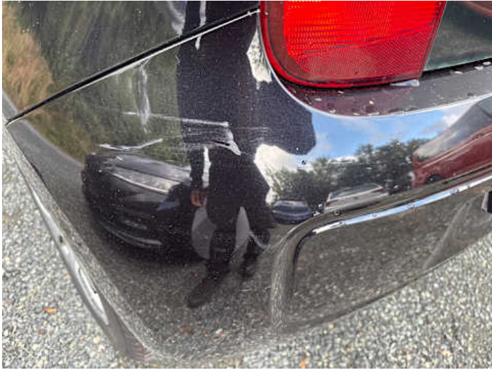
Stoßstange hinten (Kratzer, Lackschaden)
