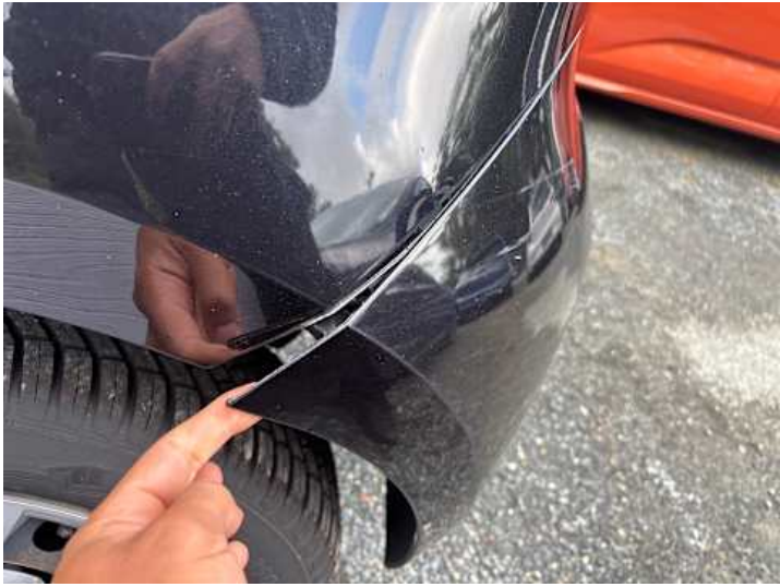
Stoßstange hinten (Riss/Bruch, Spaltmaße ungenau)
