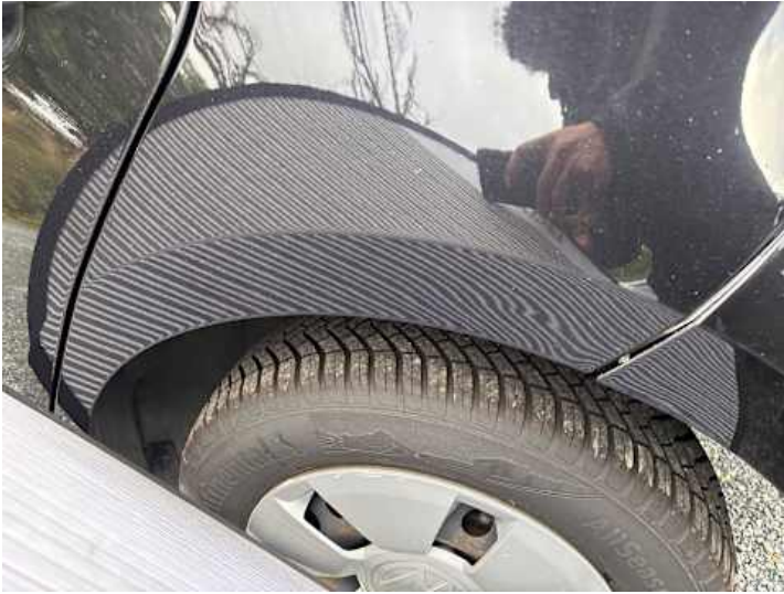
Seitenteil hinten links (Delle)
