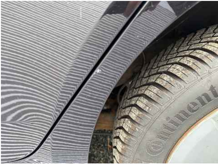
Seitenteil hinten links (Kratzer, Delle)
