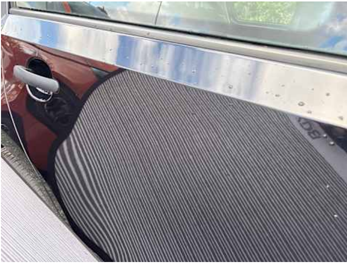
Türe hinten rechts (Delle)
